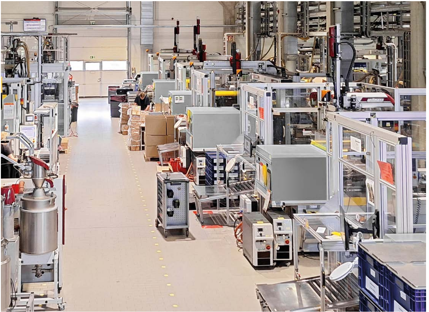
Insgesamt sind 14 Produktionszellen mit einer standardisierten Automatisierungszelle ausgerüstet.
