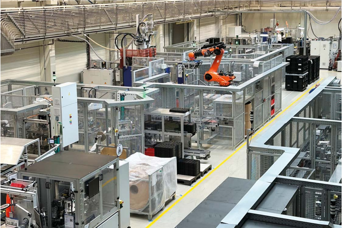
Die Automatisierung mit ausgeklügeltem Transfersystem umschließt die Spritzgießmaschine.
