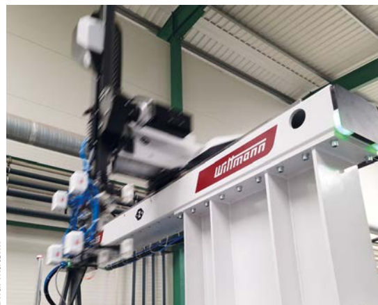
Der Sonic Hochgeschwindigkeitsroboter leistet einen wesentlichen Beitrag zur hohen Effizienz bei der IML-Herstellung der 200-ml-Rechteckbehälter.
