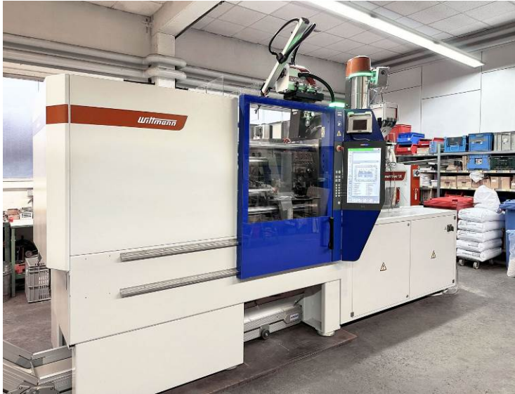
Abb. 3: Herzstück der Produktionszelle ist eine SmartPower Spritzgießmaschine mit Angusspicker. Aufgrund der hohen Energieeffizienz der servohydraulischen Maschine konnte RING Kamm und Haarschmuck vom Förderprogramm der Bundesregierung profitieren.
