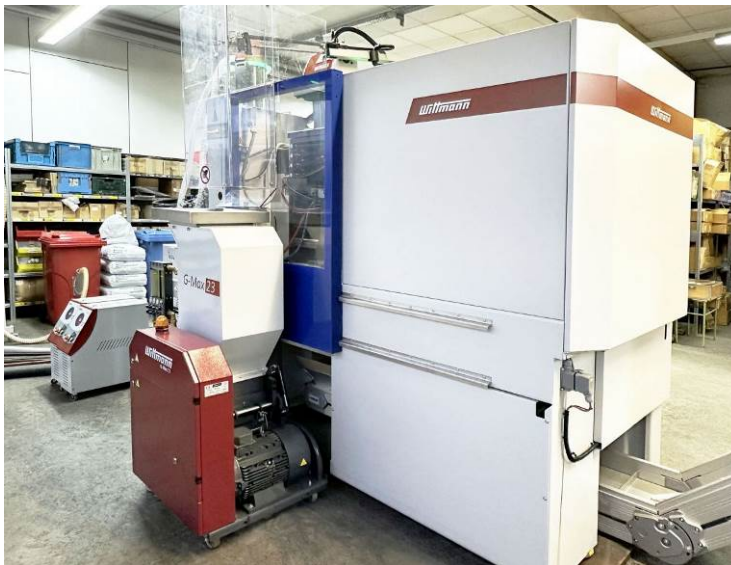
Abb. 6: Angüsse werden direkt vermahlen. Für die Herstellung der Drogerieartikel können bis zu 10 Prozent Mahlgut der Neuware zugemischt werden.
