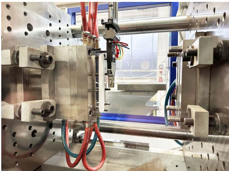
Abb. 4: Die vergleichsweise großen Werkzeugaufspannplatten der SmartPower Spritzgießmaschine bieten viel Flexibilität, um die unterschiedlichsten und auch größere Werkzeuge zu rüsten.
