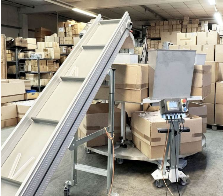
Abb. 5: Das zweistöckige Produktkarussell ermöglicht die autonome Produktion über bis zu 18 Stunden.
