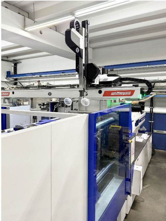
Abb. 3: Der Sonic Hochgeschwindigkeitsroboter wurde gezielt für schnelllaufende Anwendungen in der Verpackungsindustrie entwickelt.
