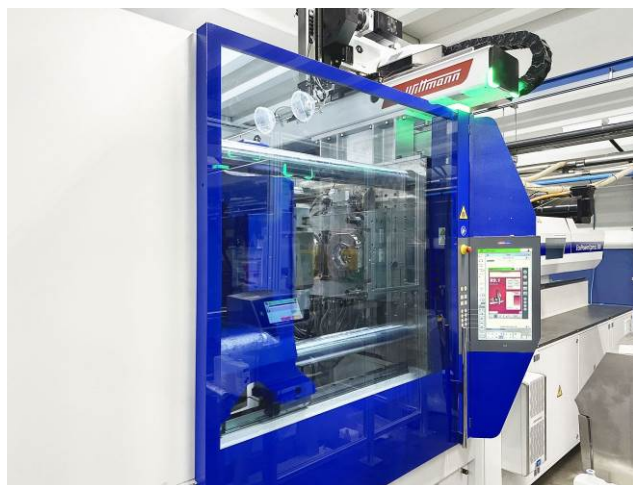
Abb. 4a+b: Die steuerungstechnische Integration von Spritzgießmaschine und Roboter vereinfacht die Bedienung der Produktionszelle.
