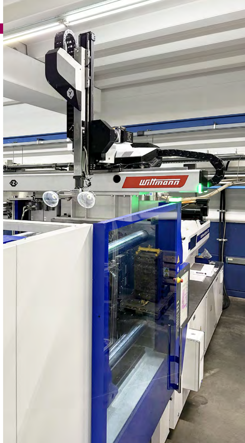
Der Sonic Hochgeschwindigkeits-Roboter wurde gezielt für schnelllaufende Anwendungen in der Verpackungsindustrie entwickelt.
