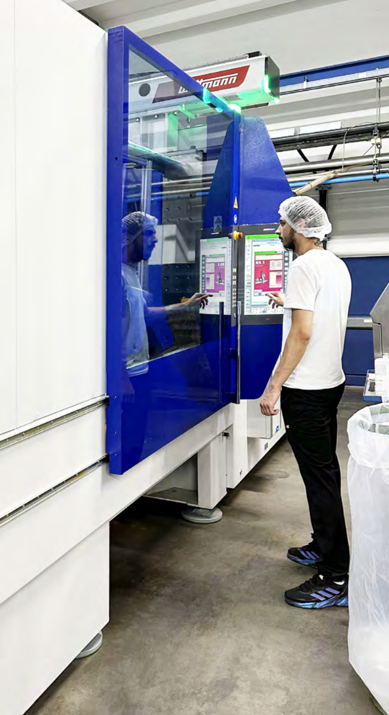
Die steuerungstechnische Integration von Spritzgießmaschine und Roboter vereinfacht die Bedienung der Produktionszelle.
