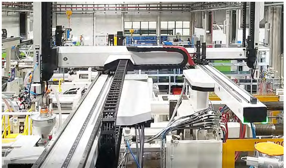
Zwei W843 pro Roboter entnehmen zeitversetzt je zwei Teile aus zwei benachbarten Maschinen.
