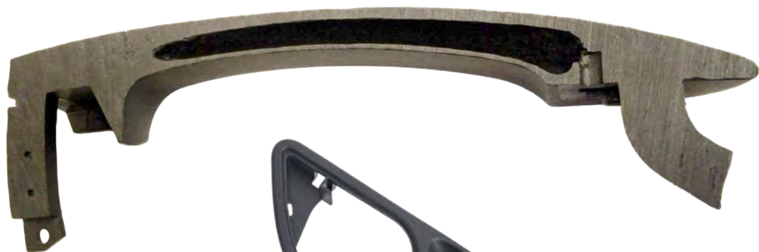
Airmould-Kanal in einem Türgriff.
