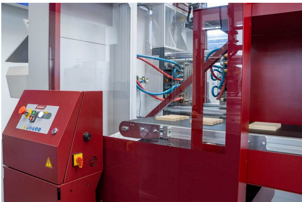
Abb. 4: WITTMANN S-Max-Mühle zur Vermahlung der Angüsse
