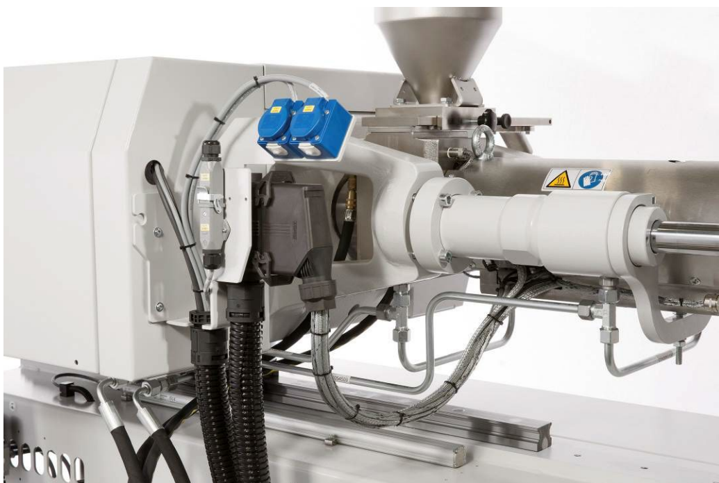
Fig. 4: Connecteur sur l'unité d'injection pour une meilleure facilité d'entretien
