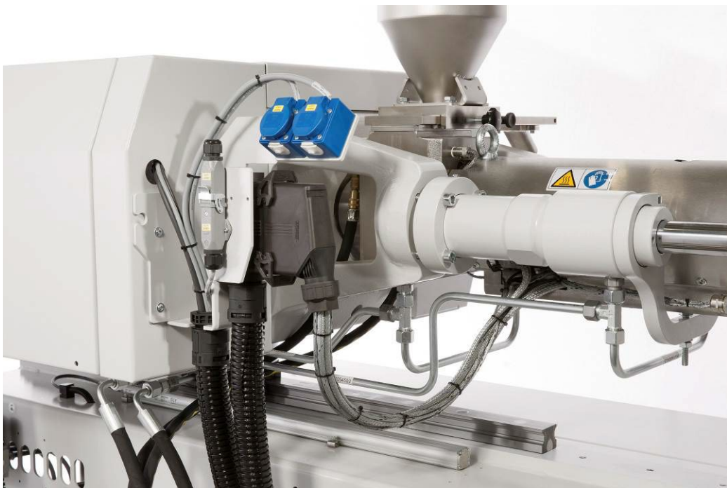
Abb. 4: Summenstecker am Spritzaggregat für bessere Servicierbarkeit
