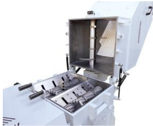
Mahlkammer mit der zusätzlichen Einzugswalze im schwenkbaren Teil des Materialtrichters.
