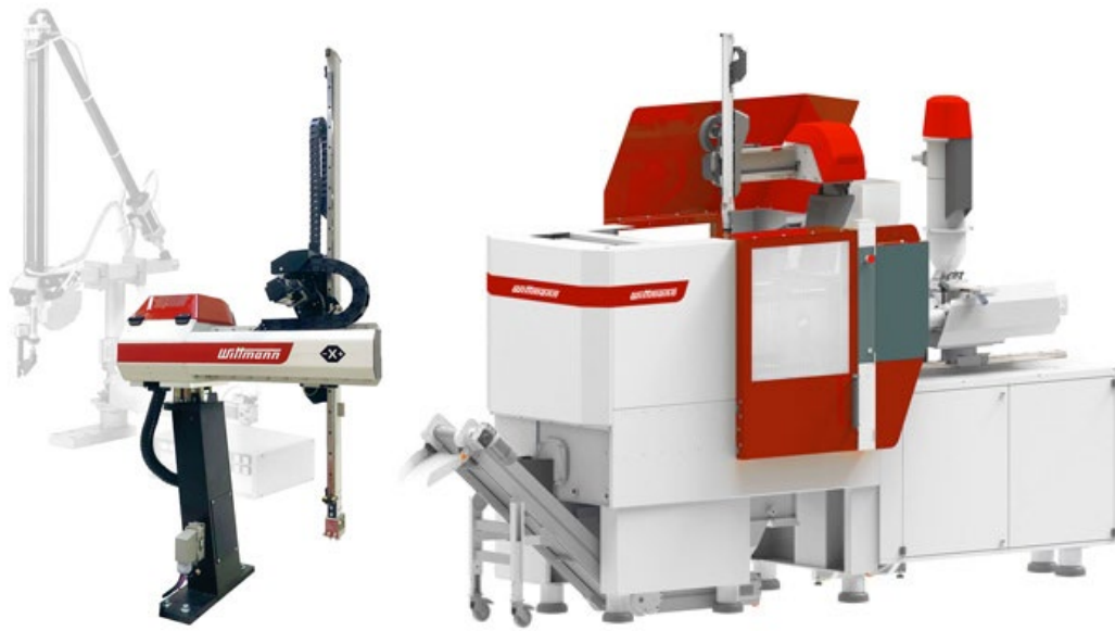
À gauche, le nouveau pique-carotte WX90 (en arrière-plan, l'un des premiers modèles pneumatiques historiques), à droite une presse à injecter EcoPower avec un pique-carotte WX90 entièrement intégré.
