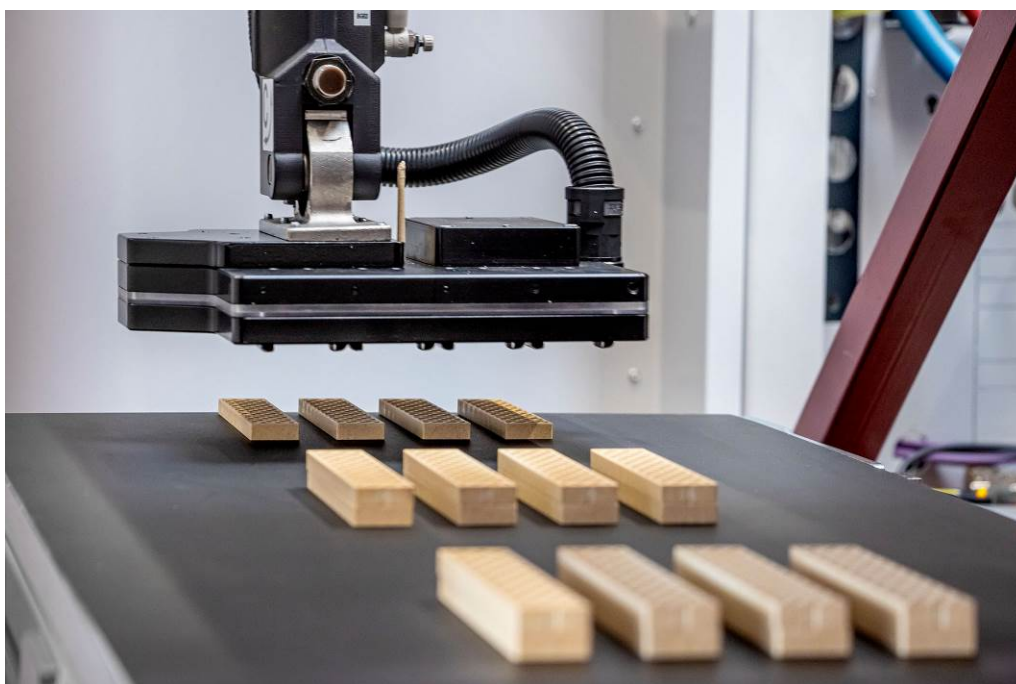
Abb. 4: Ablage der Bioblo-Bausteine auf Förderband
