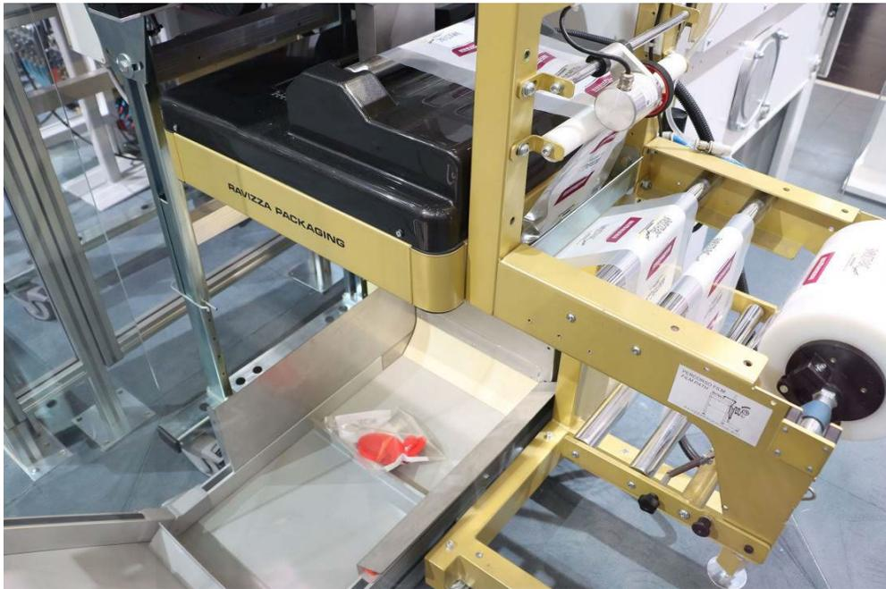
**Abb. 3:** Verpackung der Teile mit Schlauchbeutelanlage
