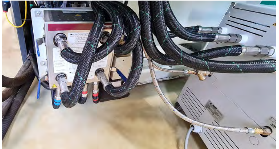
Links im Bild die Water Switch Box, rechts die Rückseite eines Temperiergeräts.
