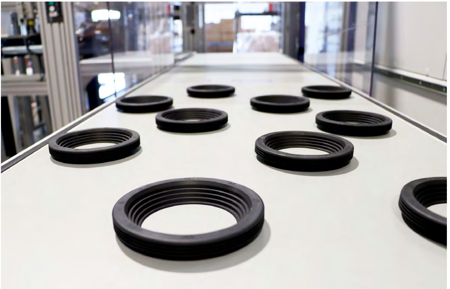
Die auf dem Förderband abgelegten Dichtungen.
