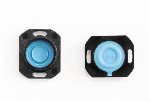
Abb. 2a+b: Membrane aus Thermoplast und Flüssigsilikon für hochwertigen Kleinst-Lautsprecher, hergestellt mit einer MicroPower 15/10H/10H Combimould
