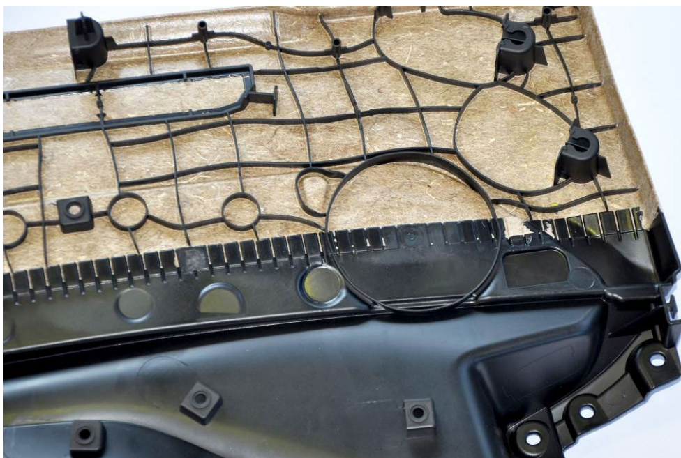
Fig. 4: un panneau d'intérieur de porte de voiture constitué d'un matelas de fibres naturelles et de recyclats, produit sur une MacroPower 1100 - moule fourni par FRIMO (photo : FRIMO)
