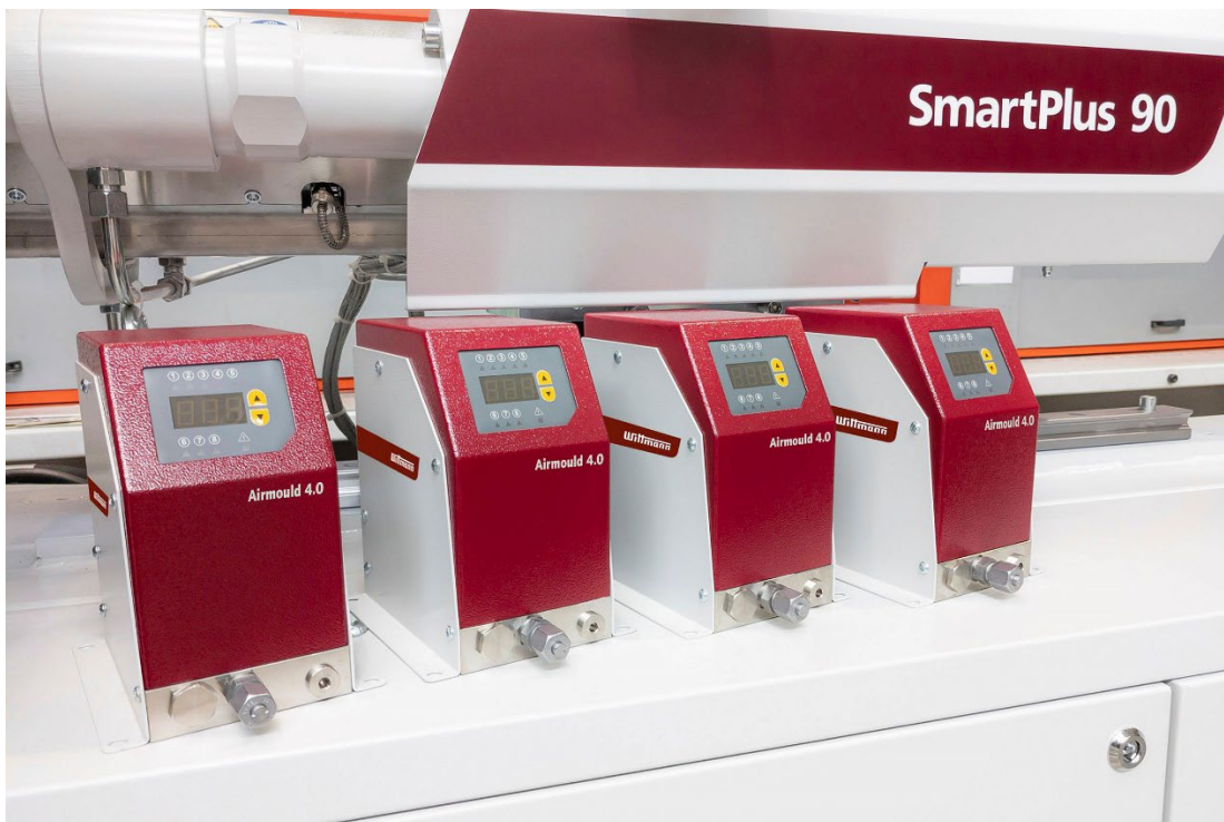
Abb. 3: Air mould 4.0 Module, klein und zentral an der Spritzgießmaschine
