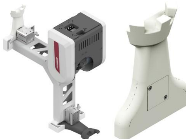
A/C-Servoachse mit Greifer, Spielstein.
