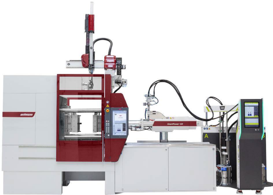
Abb. 6: SmartPower 120/350 LIM mit Nexus X200 Dosieranlage (Foto: WITTMANN BATTENFELD)
