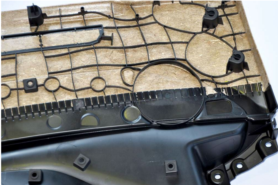
Abb. 4: Türinnenverkleidung aus Naturfasermatte und Rezyklat, hergestellt mit einer MacroPower 1100 und einem Werkzeug der Firma FRIMO (Foto: FRIMO)
