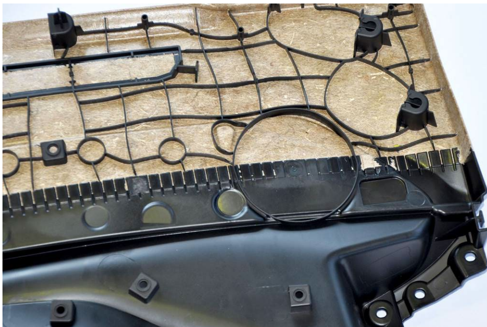
Abb.: Türinnenverkleidung aus Naturfasermatte und Rezyklat, hergestellt mit einer MacroPower 1100 und einem Werkzeug der Firma FRIMO (Foto: FRIMO)
