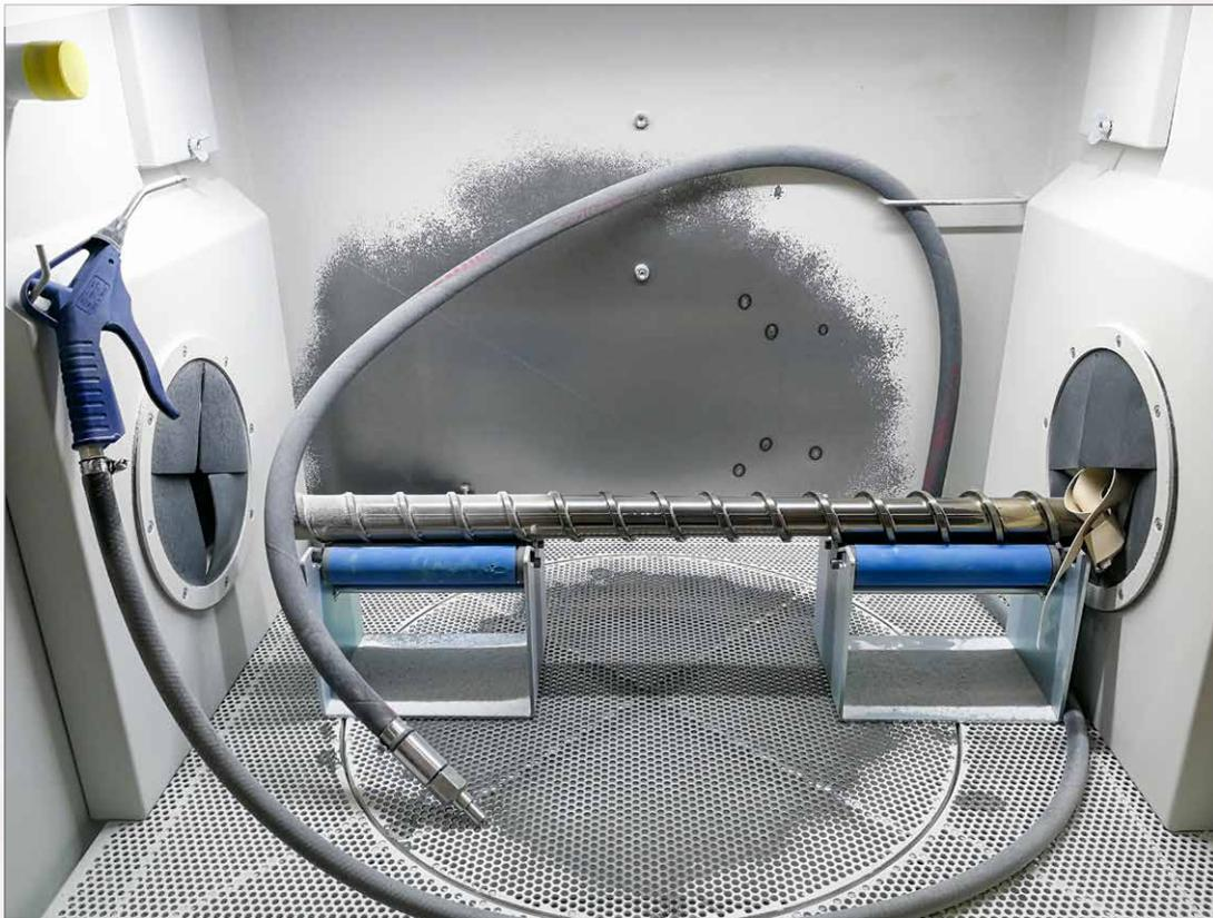
Unsere Strahlanlage ermöglicht eine rückstandslose Reinigung stark mit Kunststoff verschmutzter Komponenten wie Schnecken, Düsenköpfe, RSPs, Düsen etc.
