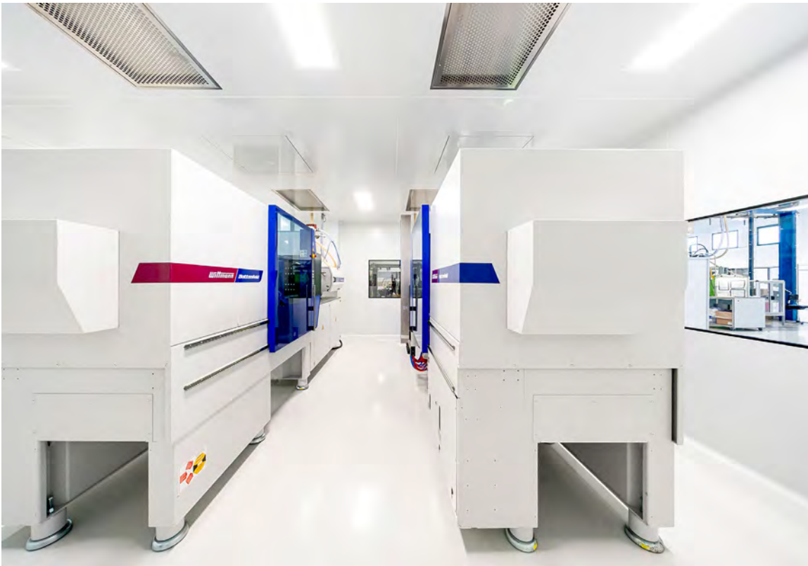
Inyectoras WITTMANN BATTENFELD EcoPower 110T en sala blanca de FBT Plastics. Una ventaja de EcoPower es su diseño de fácil uso. En el desarrollo de esta serie de máquinas, se hizo especial hincapié en el tamaño reducido y la integración compacta.
