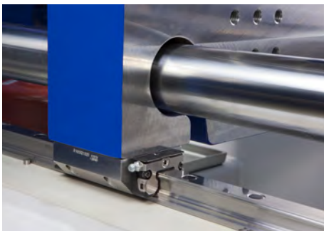
La portada muestra la guía lineal de una máquina de moldeo por inyección WITTMANN BATTENFELD.
