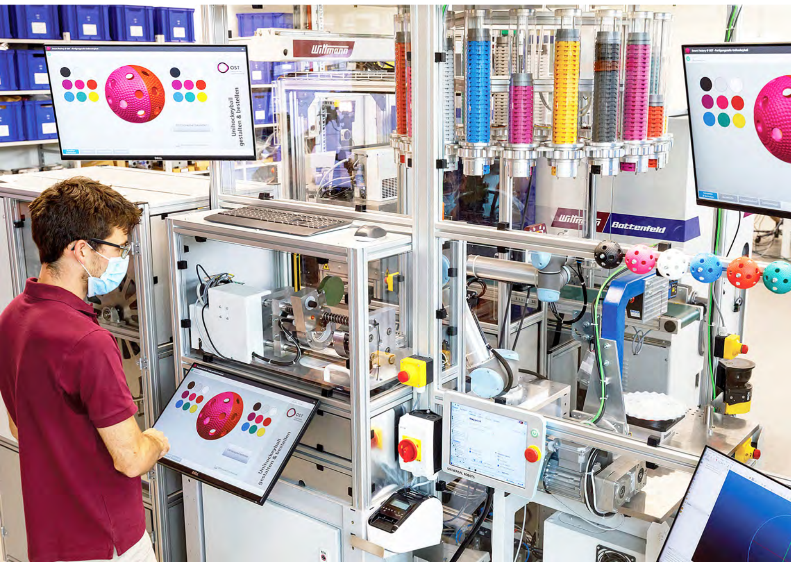
La celda de producción Smart Factory en la Universidad de Ciencias Aplicadas de Suiza Oriental (OST) en Rapperswil fabrica bolas de Floorball personalizadas en una gama de diferentes colores. (Fotos: Departamento IWK de la OST)
