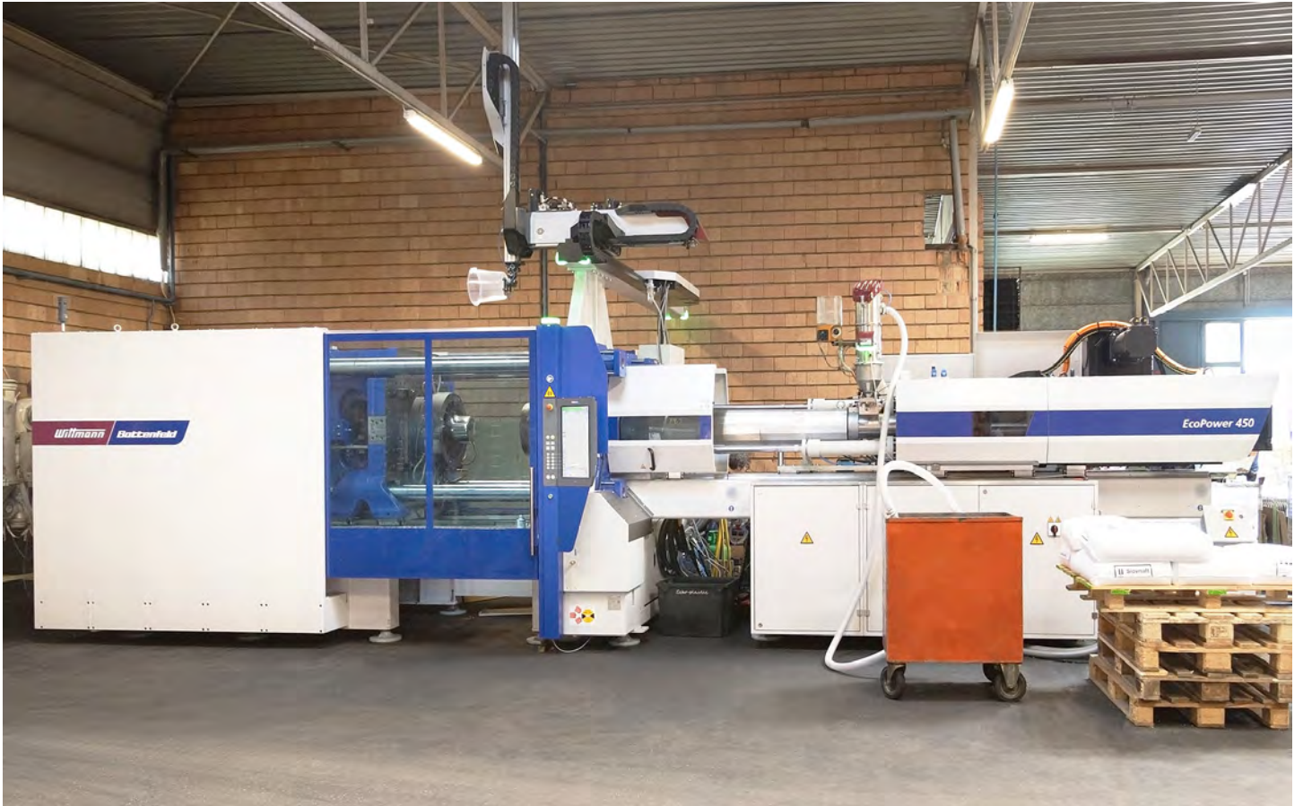
EcoPower 450/3300 con cargador de material básico WITTMANN Feedmax y robot profesional W832 que acaba de quitar una cubeta terminada de la máquina. Cubeta de plástico con un volumen de 10 litros producida en ambas máquinas con fines de comparación.
