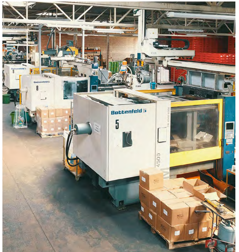
Teilansicht der Teko-plastic Fertigung in Preding. Für den Energievergleich mit der EcoPower wurde eine BATTENFELD TM 4500 Spritzgießmaschine herangezogen (im Bild vorne rechts). (Foto: Teko-plastic)
