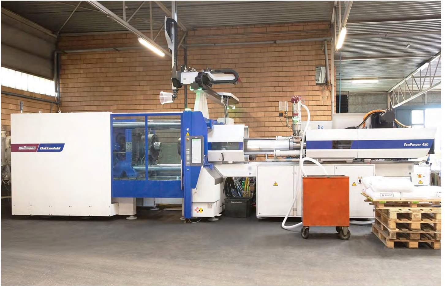
EcoPower 450/3300 Spritzgießmaschine mit FEEDMAX basic Fördergerät und W832 pro Roboter, der einen Eimer aus der Maschine entnimmt. Dieser Kunststoffeimer mit einem Volumen von 10 l wurde zu Vergleichszwecken auf beiden Maschinen produziert.
