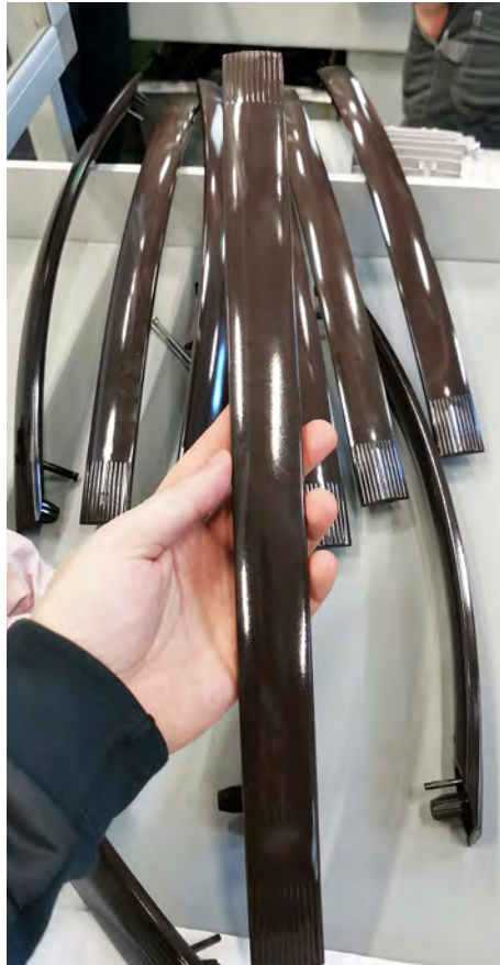
Manijas de puertas de electrodomésticos moldeadas por inyección por GEFEST, aplicando la tecnología WITTMANN BATTENFELD AIRMOULD®.
