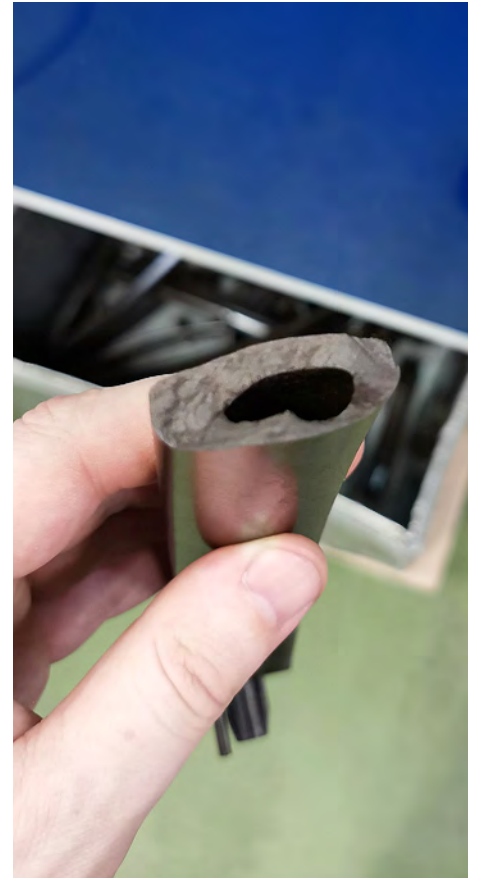
Manijas de puertas de electrodomésticos moldeadas por inyección por GEFEST, aplicando la tecnología WITTMANN BATTENFELD AIRMOULD®.
