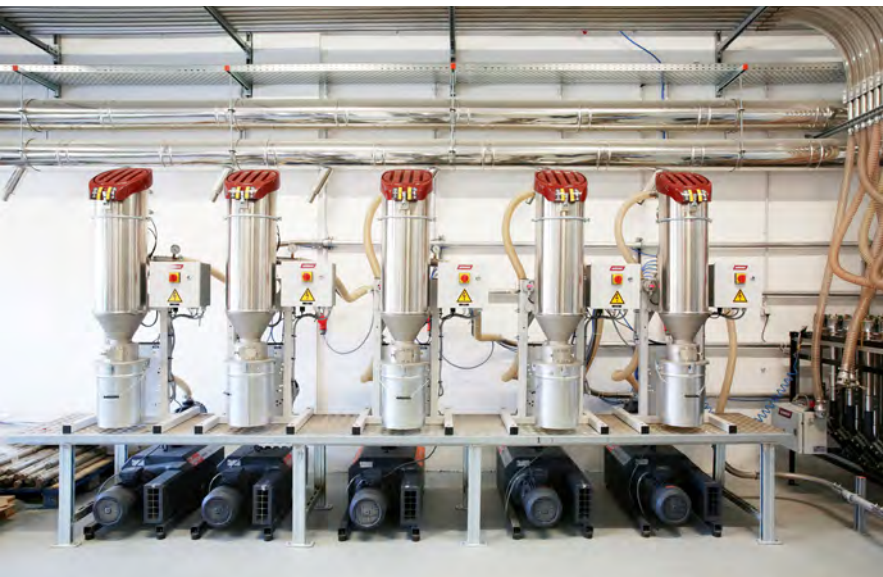
Vistas del sistema central de transporte y secado WITTMANN instalado en CER en Curtea de Arges.
