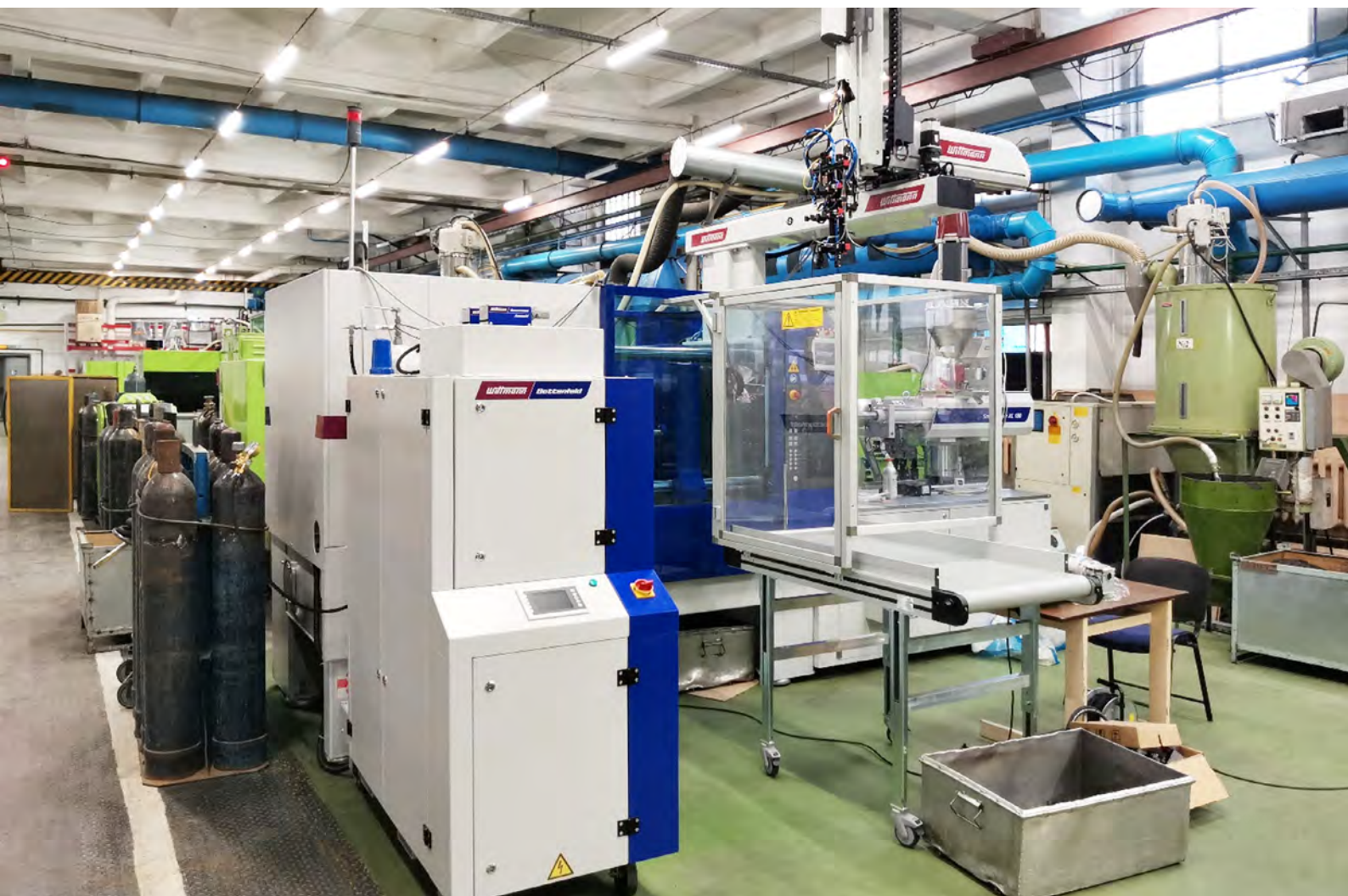
Vistas de una celda de producción del Grupo WITTMANN en la planta de producción de GEFEST en Brest, Bielorrusia, la cual consta de una máquina de moldeo por inyección WITTMANN BATTENFELD SmartPower XL180 y un robot PRIMUS 26T de WITTMANN, así como diferentes auxiliares de WITTMANN, como equipos de transporte y controladores de temperatura.
