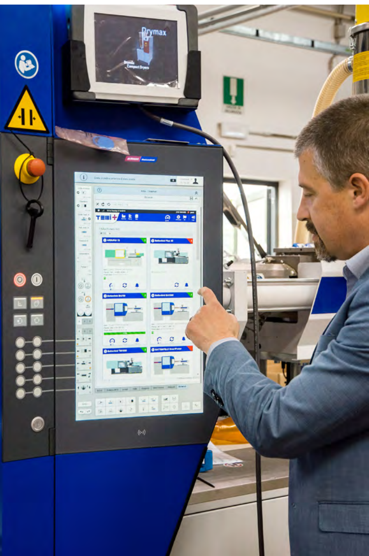
El sistema MES instalado en la planta de Stamplast en Belluno permite controlar el proceso de producción no solo directamente en la máquina, sino que también brinda acceso remoto.
