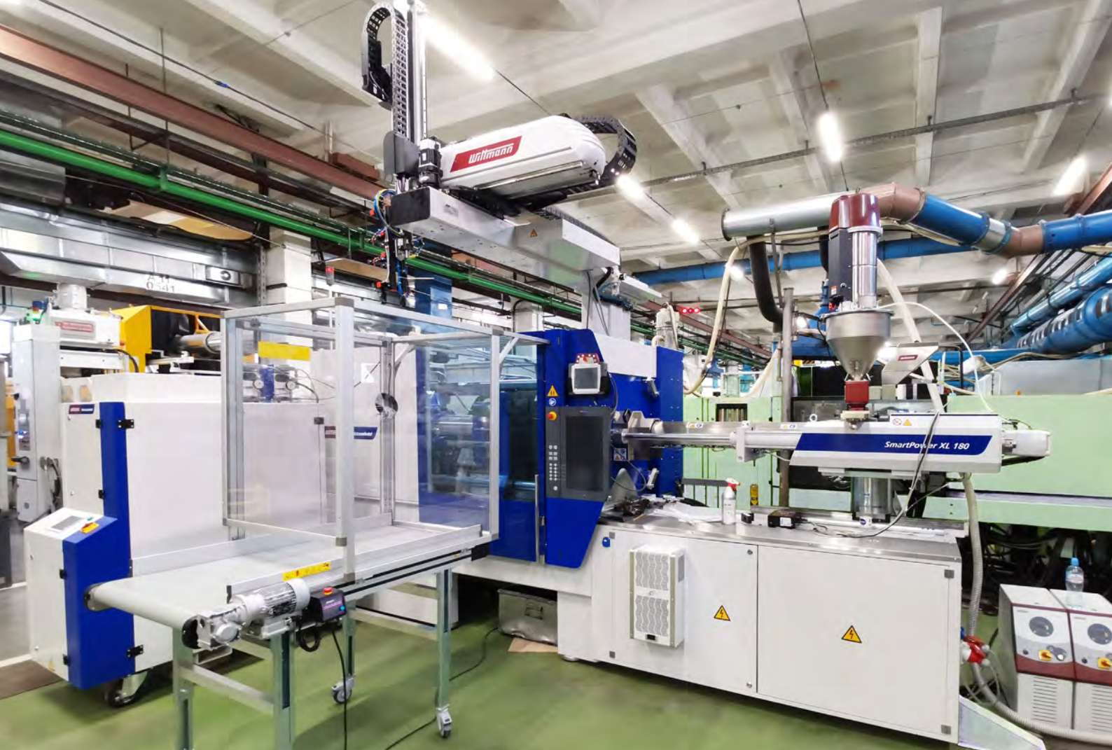
Vistas de una celda de producción del Grupo WITTMANN en la planta de producción de GEFEST en Brest, Bielorrusia, la cual consta de una máquina de moldeo por inyección WITTMANN BATTENFELD SmartPower XL180 y un robot PRIMUS 26T de WITTMANN, así como diferentes auxiliares de WITTMANN, como equipos de transporte y controladores de temperatura.
