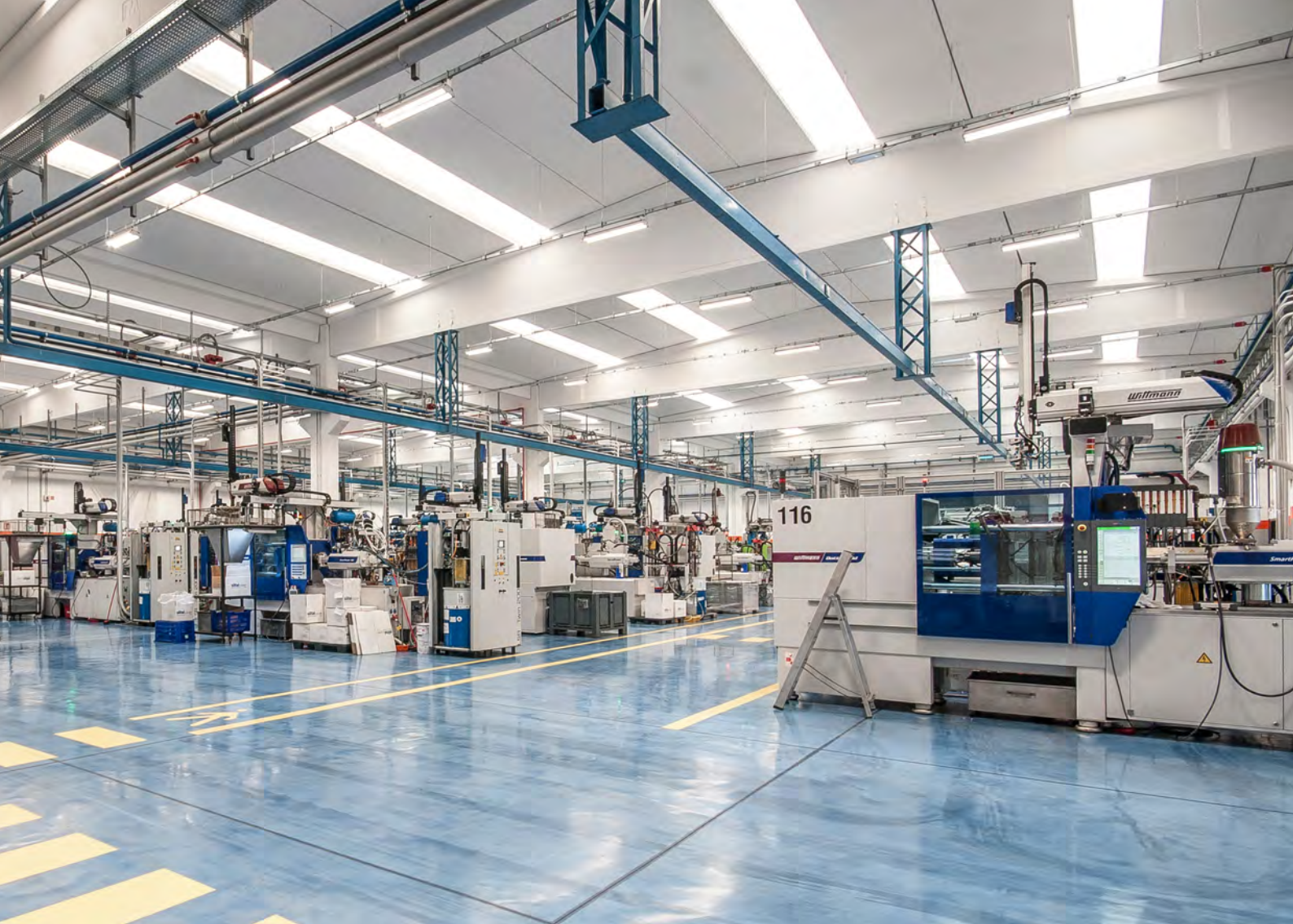
Producción de moldeo por inyección de Oldrati en Villongo, Bérgamo: Máquinas de moldeo por inyección WITTMANN BATTENFELD con equipos de automatización de WITTMANN hasta donde alcanza la vista.
