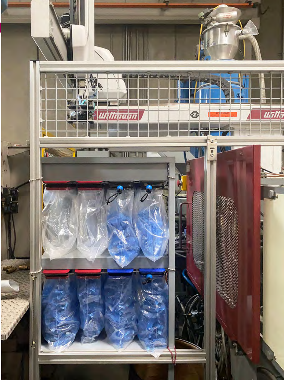
El robot WITTMANN PRIMUS separa cavidades, cuenta y empaqueta las piezas dentales en bolsas para su envío.
