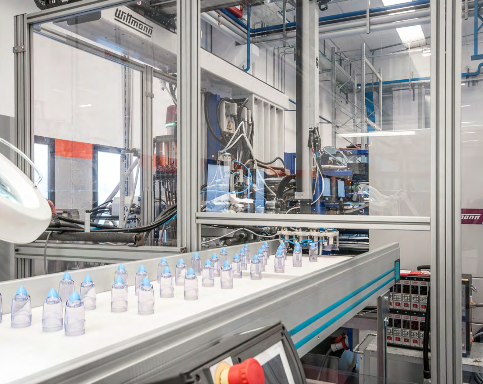
El Grupo Oldrati ha desarrollado un proceso de moldeo por inyección con tecnología one-shot para piezas compuestas por termoplásticos combinados con silicona, incluyendo moldes especialmente diseñados para los procesos necesarios de calentamiento y enfriamiento. Esta imagen muestra una célula de trabajo del Grupo WITTMANN.
