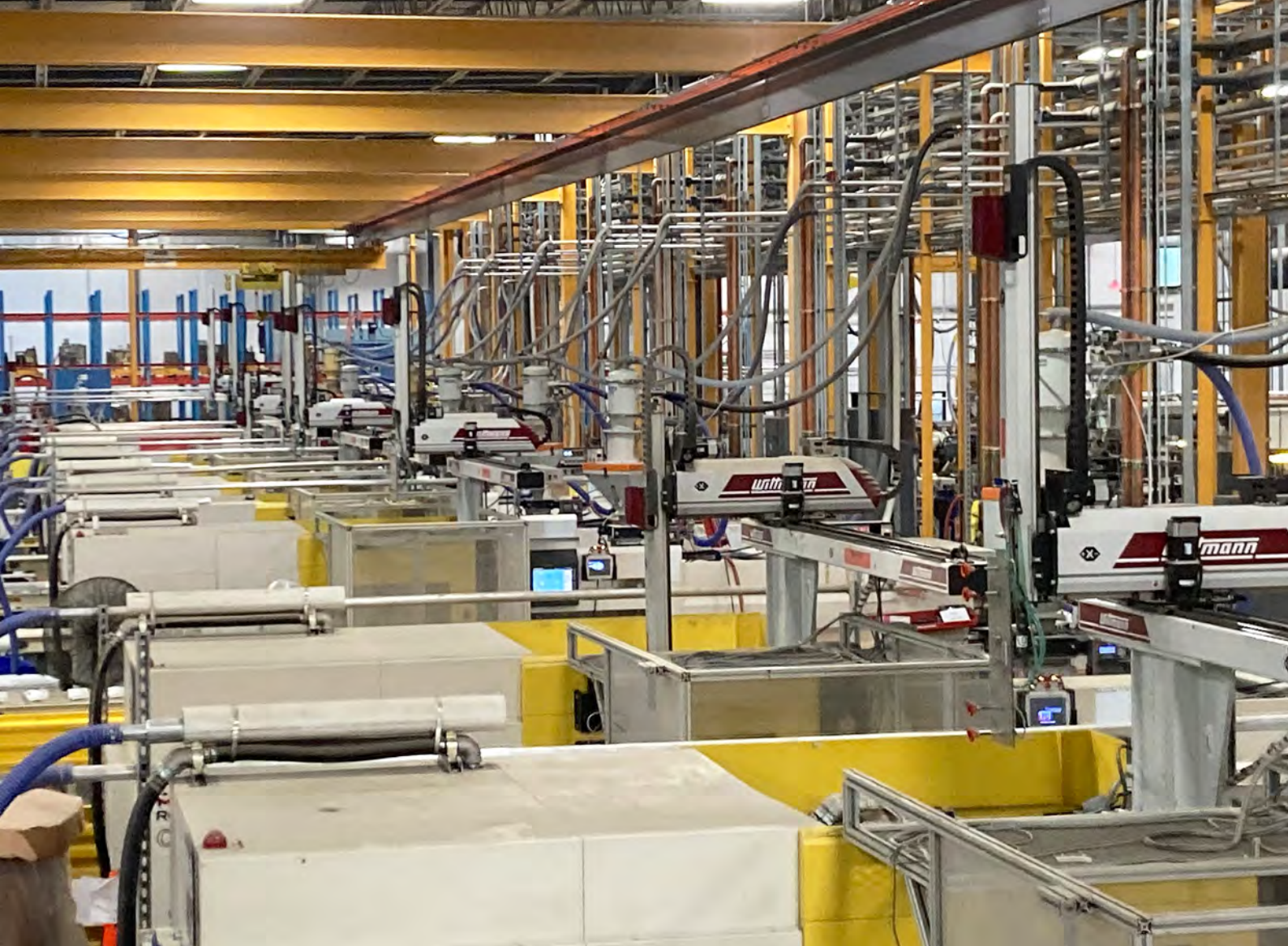
Planta de producción de Bell Laboratories, Inc., Wisconsin, EE. UU., mostrando los robots WITTMANN de la compañía en funcionamiento.
