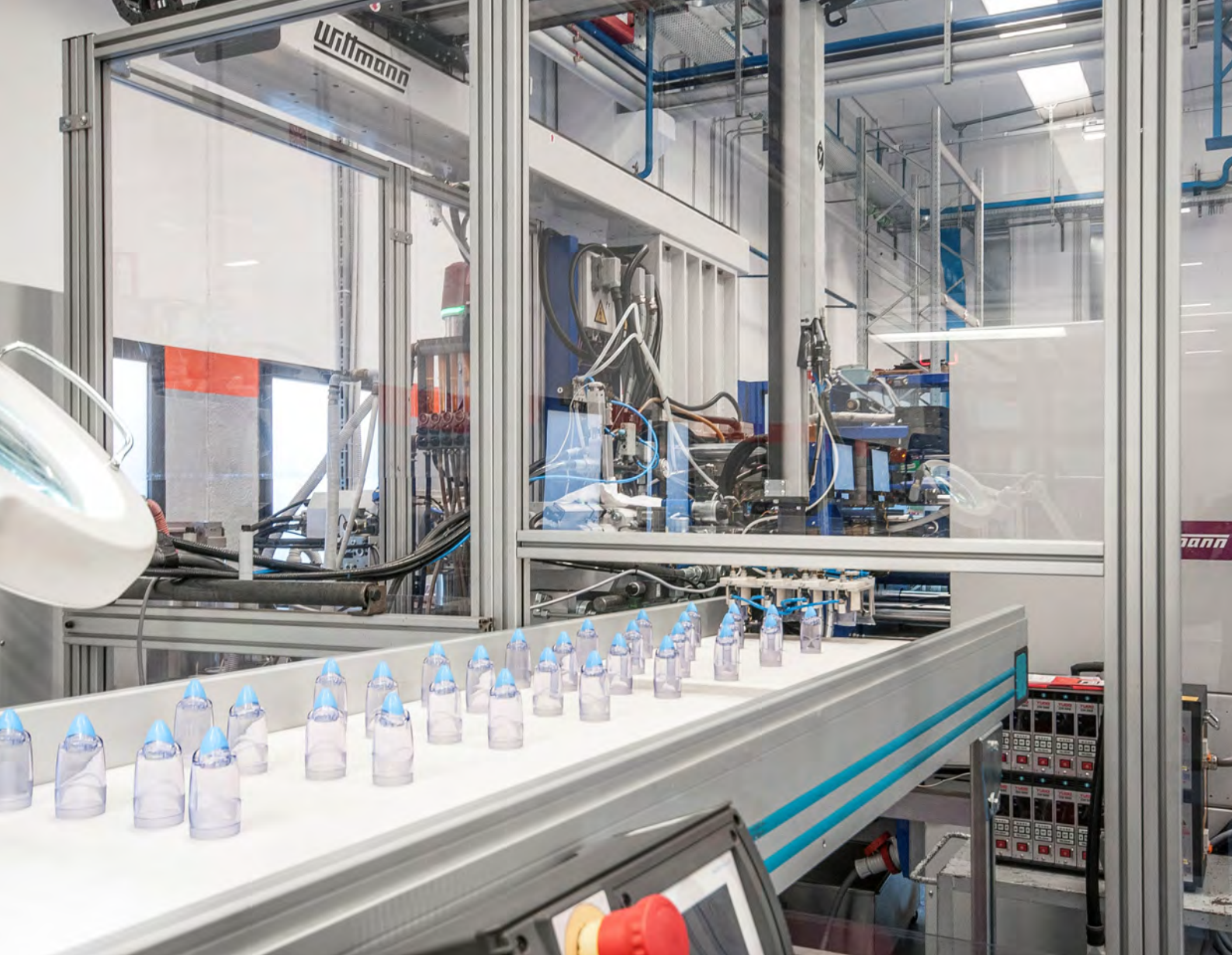
Die Oldrati Group hat ein Spritzgießverfahren mit One-Shot-Technologie für Bauteile aus Thermoplasten und Silikon entwickelt, einschließlich speziell konstruierter Formen, die für die entsprechenden Kühl- und Heizvorgänge geeignet sind. Im Bild eine Arbeitszelle der WITTMANN Gruppe.
