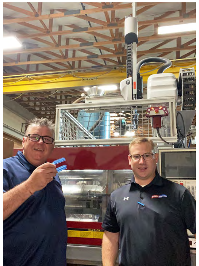
Der WITTMANN PRIMUS Roboter separiert Teile nach Kavitäten, zählt und verpackt zahnmedizinische Teile für den Versand.
