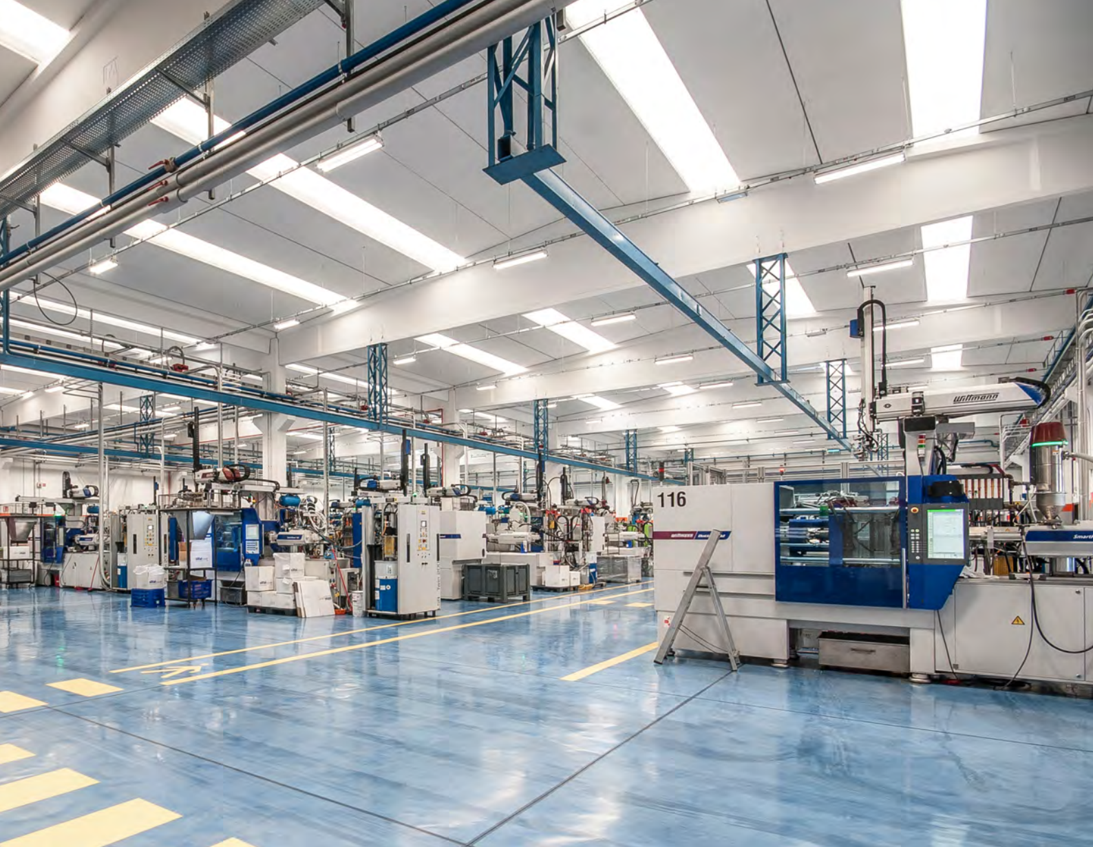
Oldrati Spritzgießproduktion in Villongo, Bergamo: WITTMANN BATTENFELD Spritzgießmaschinen mit Automatisierung von WITTMANN so weit das Auge reicht.
