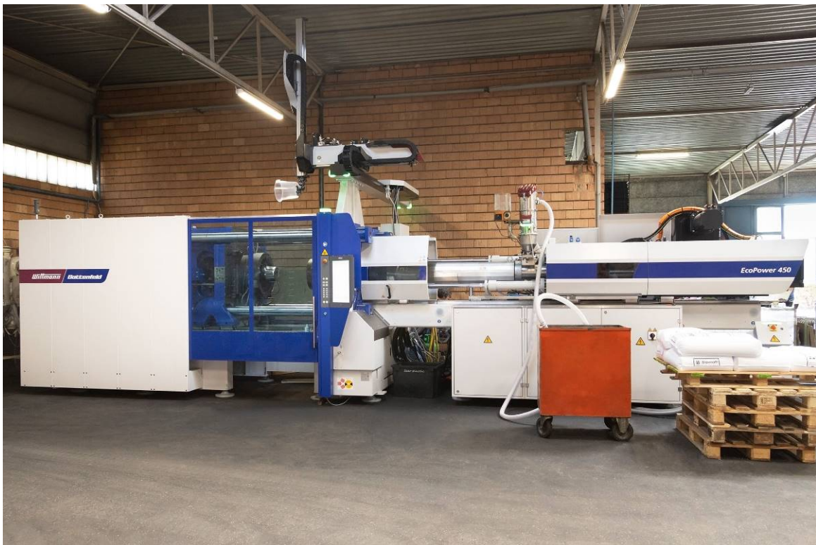
Abb. 1: EcoPower 450/3300 mit WITTMANN FEEDMAX basic Fördergerät und W832 pro Roboter, der gerade einen Eimer aus der Maschine entnimmt. (Foto: WITTMANN BATTENFELD)
