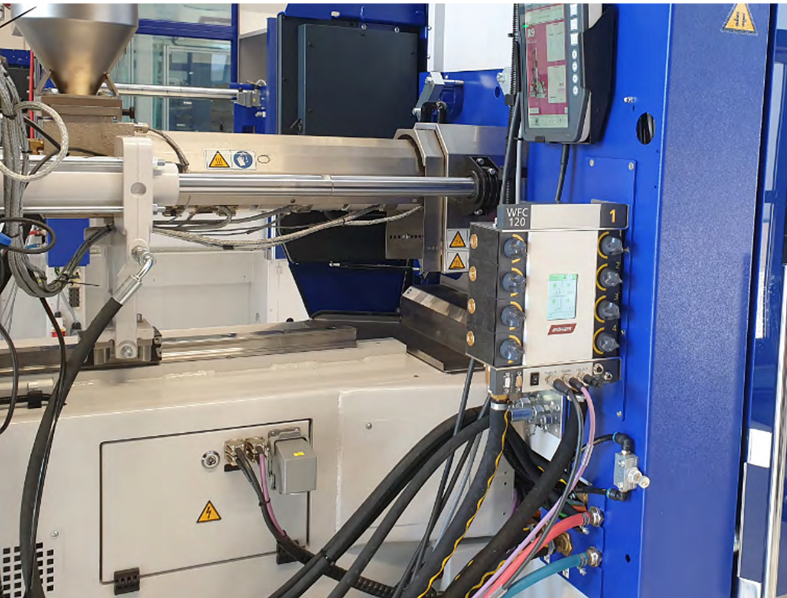
Instalación del WFC 120 cerca del molde en una máquina de moldeo por inyección WITTMANN BATTENFELD.
