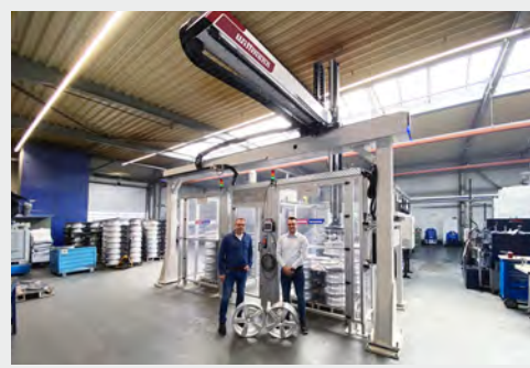
Página 14: Robots manipulando rines de aleación ALCAR
