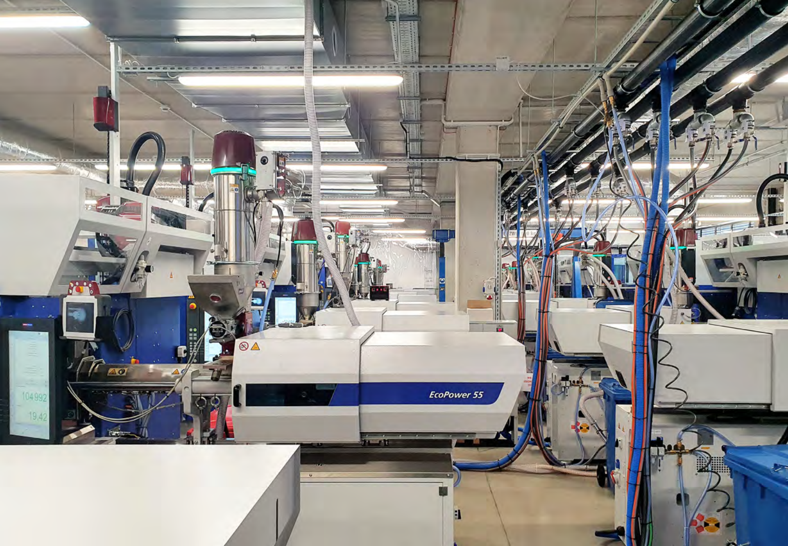
Vistas de la nueva nave de producción NOEX en Komorniki, Polonia para kits de prueba COVID, con 16 máquinas de moldeo por inyección EcoPower 55/350 Insider de WITTMANN BATTENFELD.
