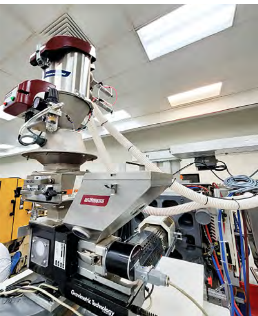
Cargadores FEEDMAX transportan resina puesta a secar fuera de la sala limpia.
