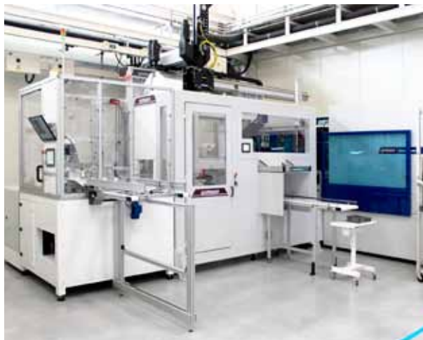
Instalación completa de celdas de trabajo en Stiplastics Healthcaring en Saint-Marcellin, Francia: máquina de moldeo por inyección WITTMANN BATTENFELD SmartPower con 300 t de fuerza de sujeción, robot WITTMANN W832 pro y sistema IML.
