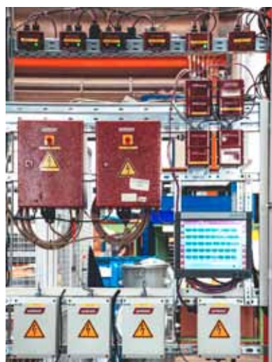
Imagen a la izquierda: Vista en primer plano de la estación de acoplamiento codificada con RFID. Imagen derecha: El "cerebro" del sistema: los módulos de bus, el servidor de línea y el control de red de pantalla táctil WITTMANN.
