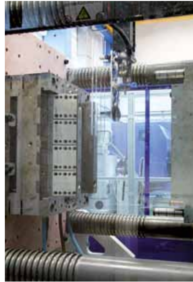
Imagen a la izquierda: MacroPower E 850/5000 con el robot WITTMANN y la correa de depósito de piezas. Imagen derecha: Extracción de un conductor de luz óptica producido en el MacroPower E del molde.
