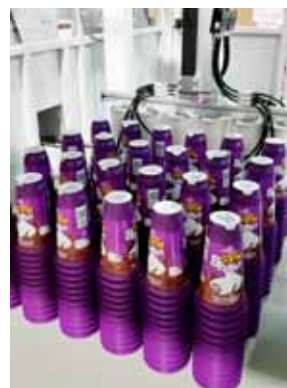
Foto izquierda: Pantalla del sistema de visión instalado en AMRAZ, mostrando la inspección de las piezas producidas. Foto derecha: Copas terminadas, apiladas en una banda transportadora usando un robot WITTMANN W818.
