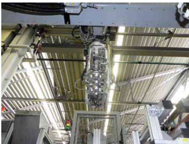
paneles se coloca en una tabla compuesta que es accionada por dos servomotores. Estos motores son similares a los modelos que normalmente permiten a un robot para llevar a cabo dos movimientos axiales adicionales en el extremo de su brazo vertical. El posicionamiento exacto de la corredera y el dispositivo de perforación se controla a través del *TeachBox* (control) del robot.
