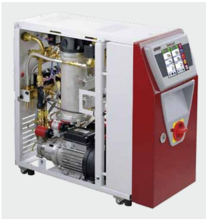
las unidades 140 °C y 160 °C – la presión del sistema se midió por primera vez, y luego controladas por encima de la presión de saturación que está sujeto a la temperatura del agua. Este enfoque garantiza el funcionamiento sin cavitación de la bomba, lo que contribuye a vida útil mayor. La estructura cerrada está llevando a un número ilimitado de moldes de descarga de volumen, ya que el agua del molde no es llevada en el intercambiador de calor, sino a la línea de retorno.
