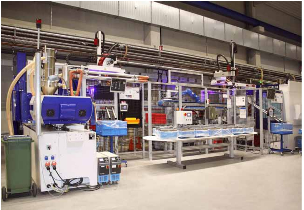
Vista general de las máquinas de moldeo por inyección EcoPower 110/350 de WITTMANN BATTENFELD unidas por sistemas transportadores con capacidad de almacenamiento.
