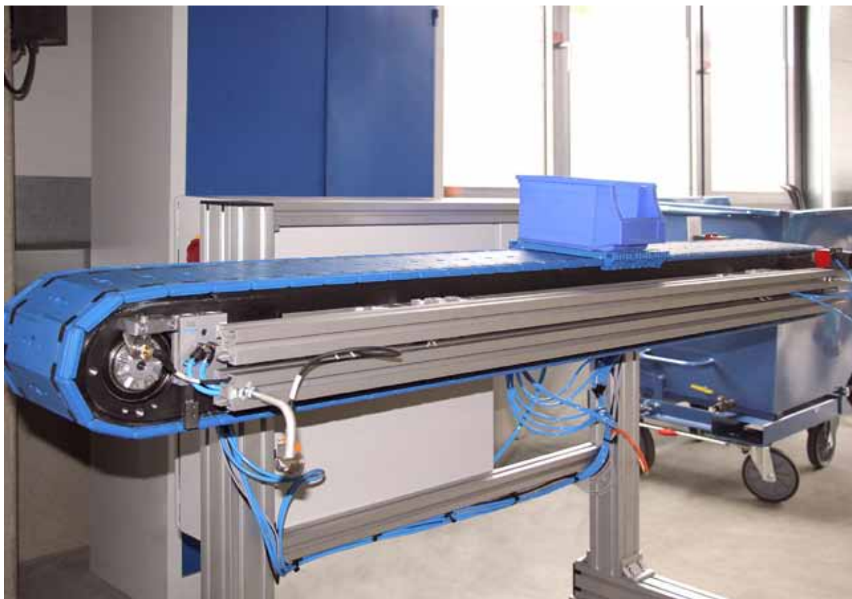
Cinta transportadora Flexi (aparato de prueba) de ErgoTek que consta de piezas de plástico fabricadas por Happ.
