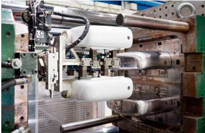
Vista del espacio del molde de la aplicación en el momento de la eliminación de piezas.
