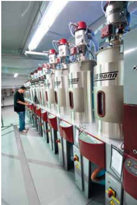
Los materiales secados y transportados bajo el sistema WITTMANN en un mezzanine es otro componente importante de la automatización en Vision Technical Molding.
