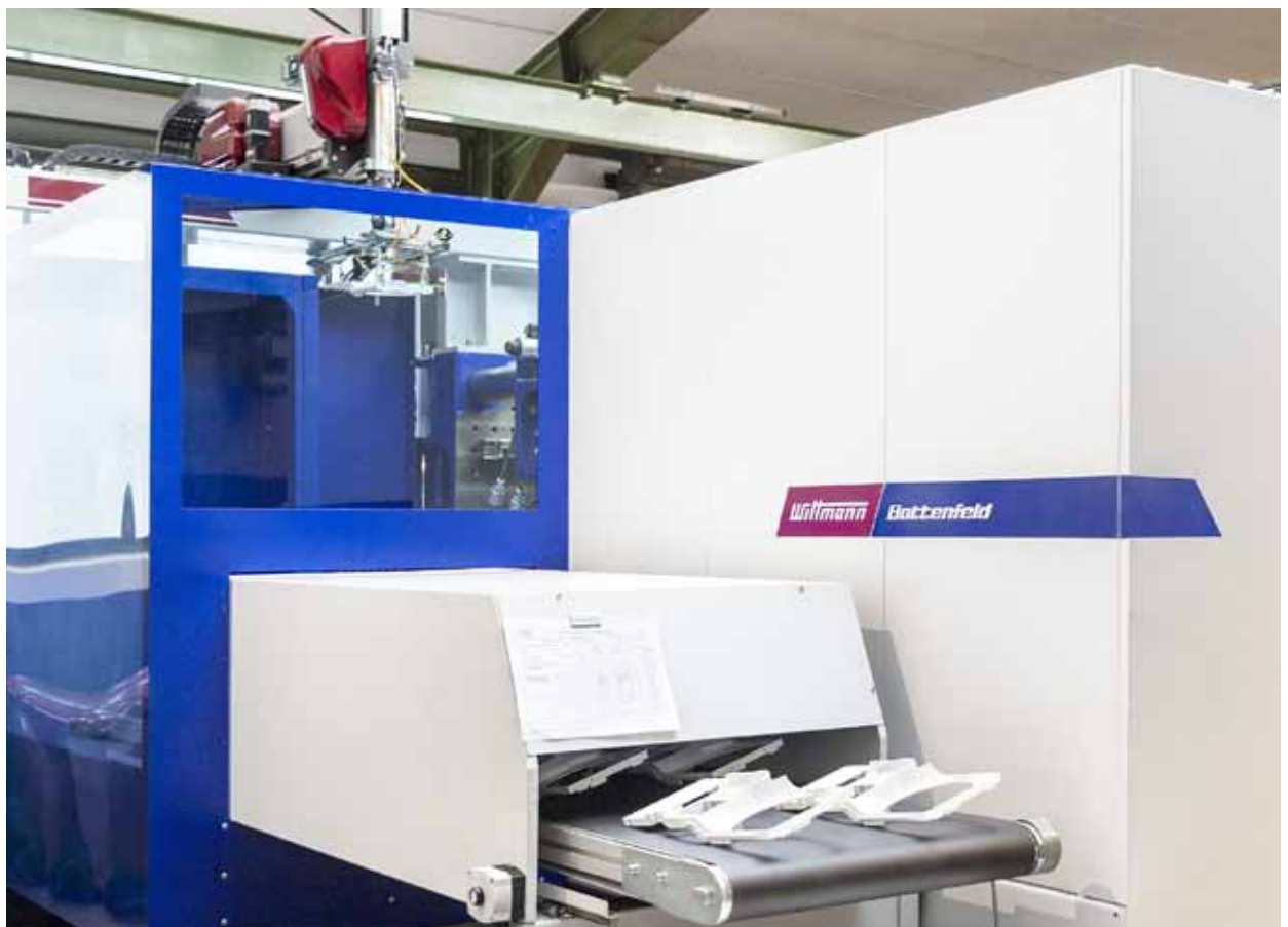
Producción de un componente de carcasas para un dispensador de bebidas: SmartPower 300/1330 con celda Insider.
