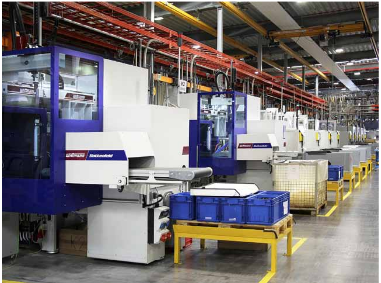
Máquinas de WITTMANN BATTENFELD en MACO en Trieben: en primer plano, la SmartPower 35 más reciente con la integración de la célula Insider y WITTMANN 4.0.
