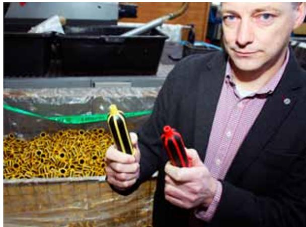
Foto izquierda: Liesa Feikes, fabricante de moldes de tercer año, selecciona un electrodo de grafito. El procesador basado en Leer fabrica estos componentes de erosión en sí. Foto derecha: Tecnología de dos componentes en diferentes colores para electrodomésticos: Holger Meyer, Director de Planta Adjunto, presenta dos asas para linternas de LDPE y TPE de color.
