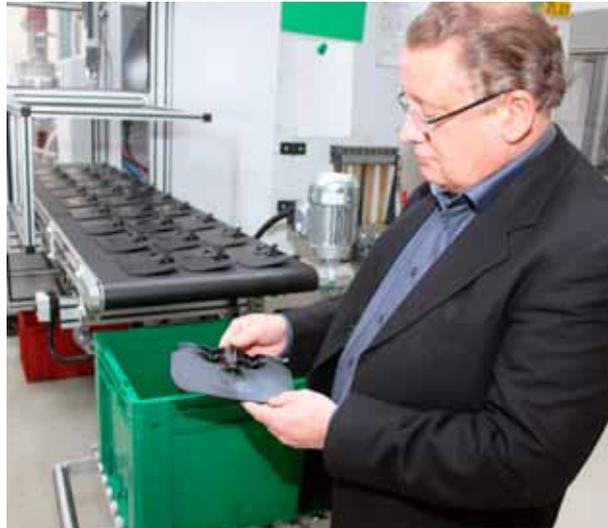
Dieter Diekmann comprueba un deflector anti-sobrevoltaje. Este deflector anti-sobrevoltaje con siesta de flujo relevante está hecho de material flexible para facilitar la inserción en el tanque de combustible. En "desplazamientos fantasma" virtuales, cientos de miles de estas piezas automotrices se producen a partir de HDPE modificado.
