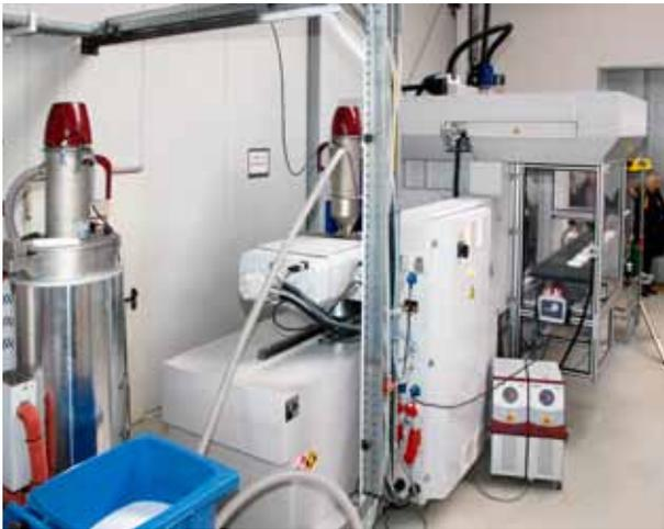
*Aumento del grado de automatización para cumplir con los estándares más altos de calidad: inserción de tornillo monitoreada por una cámara para cojinetes fijos directamente en la línea de producción.*
