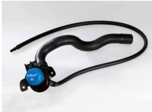
Izquierda: Tapón de AdBlue®. Derecha: Sistema AdBlue® con tapón y tubo.
