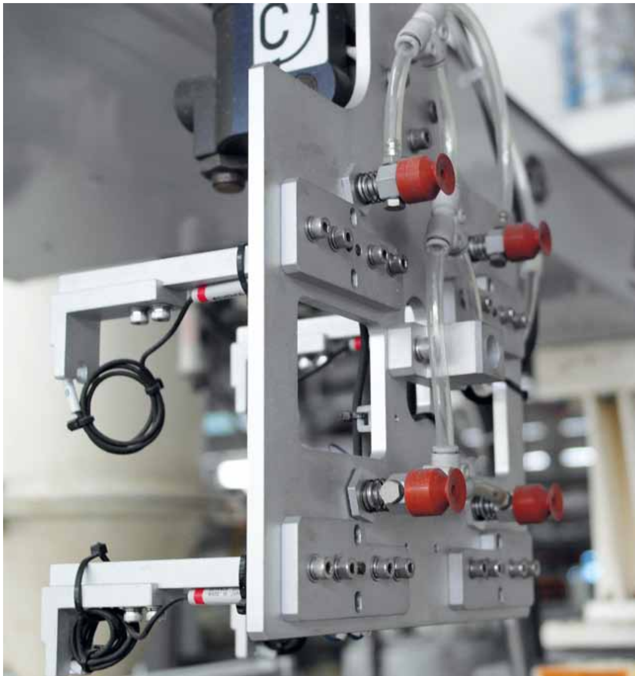
Herramientas de fin de brazo (EOAT) personalizadas de Greenland, diseñadas por WITTMANN BATTENFELD Singapur.
