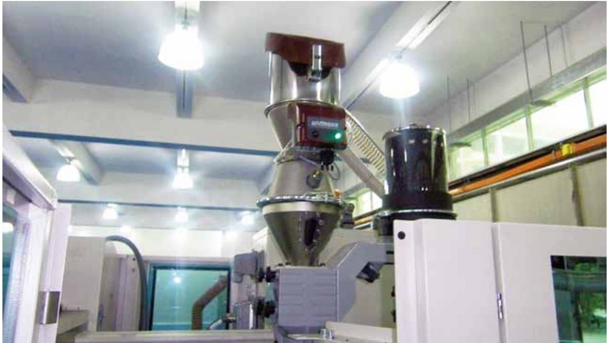
El cargador de material WITTMANN FEEDMAX, montado en una máquina de moldeo por inyección.
