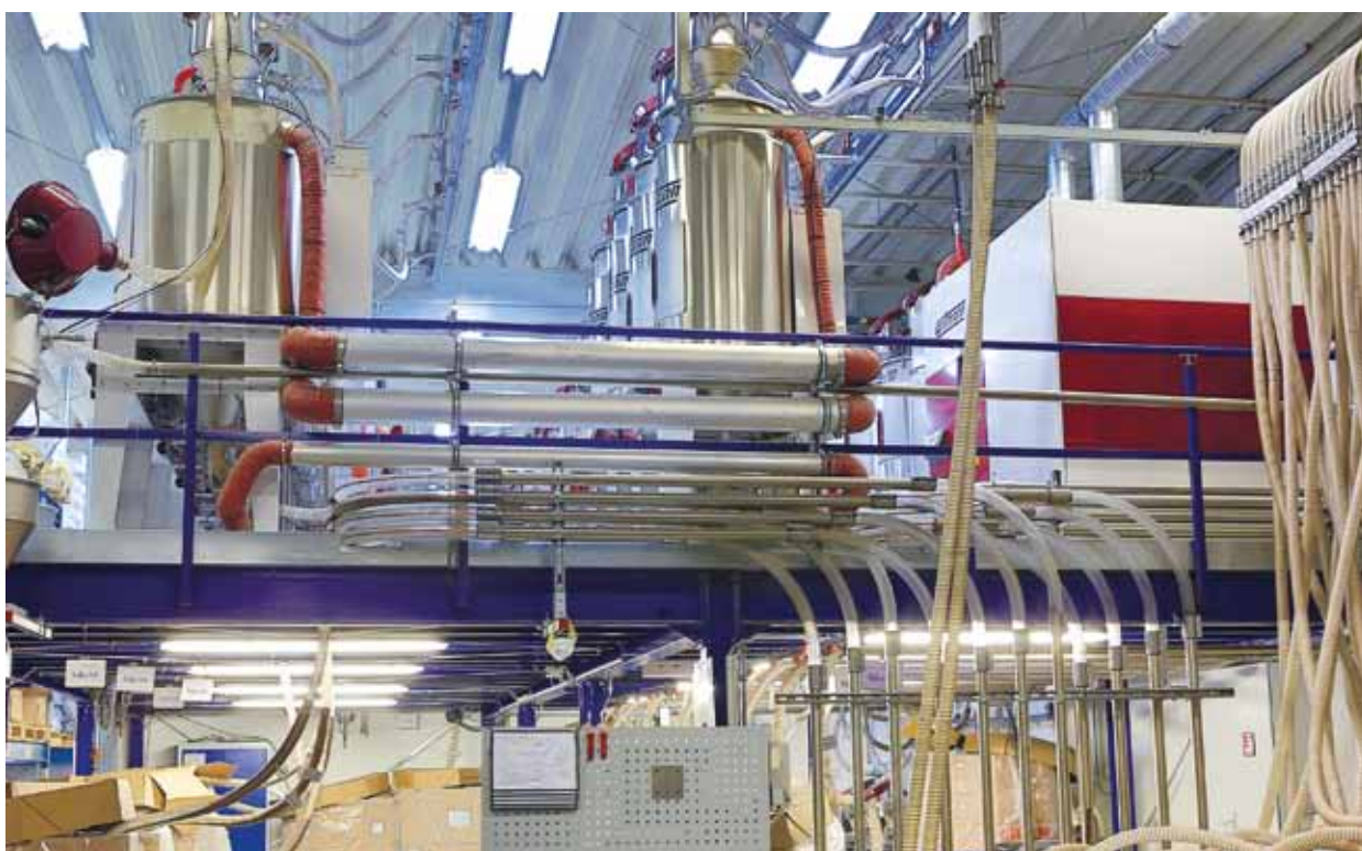
Vistas del sistema central WITTMANN de secado y sistema de transporte en Pollmann en Karlstein, Baja Austria.
