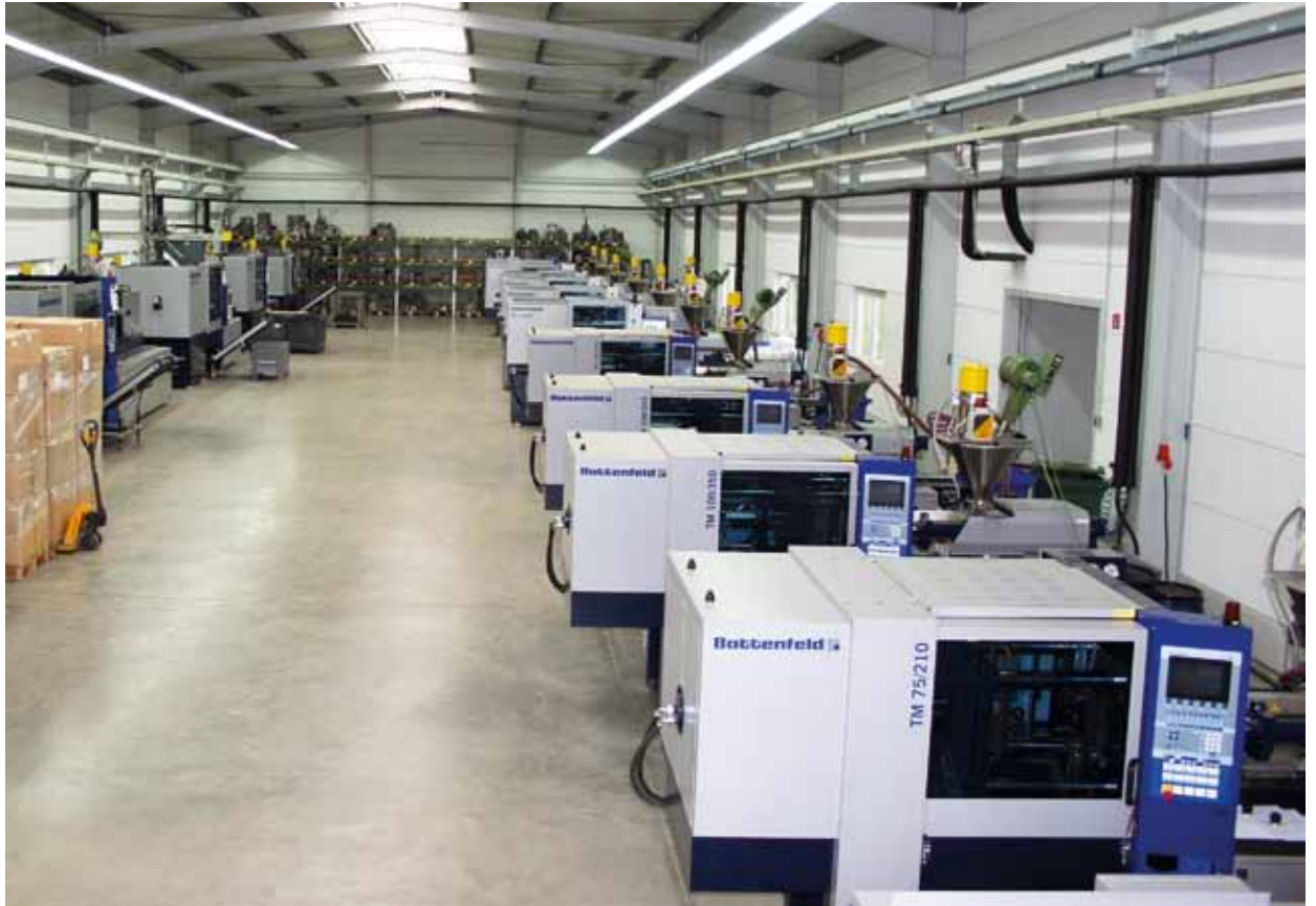
Nueva nave de producción de BECK con máquinas de inyección de plástico de WITTMANN BATTENFELD.
