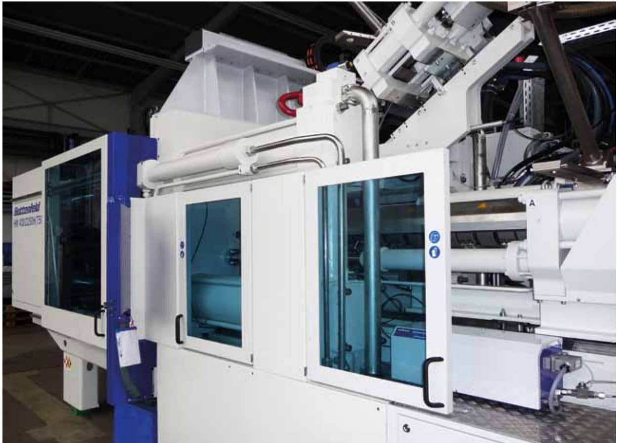
CELLMOULD® de 2-componentes, máquina de inyección de 400 toneladas de fuerza de cierre.
