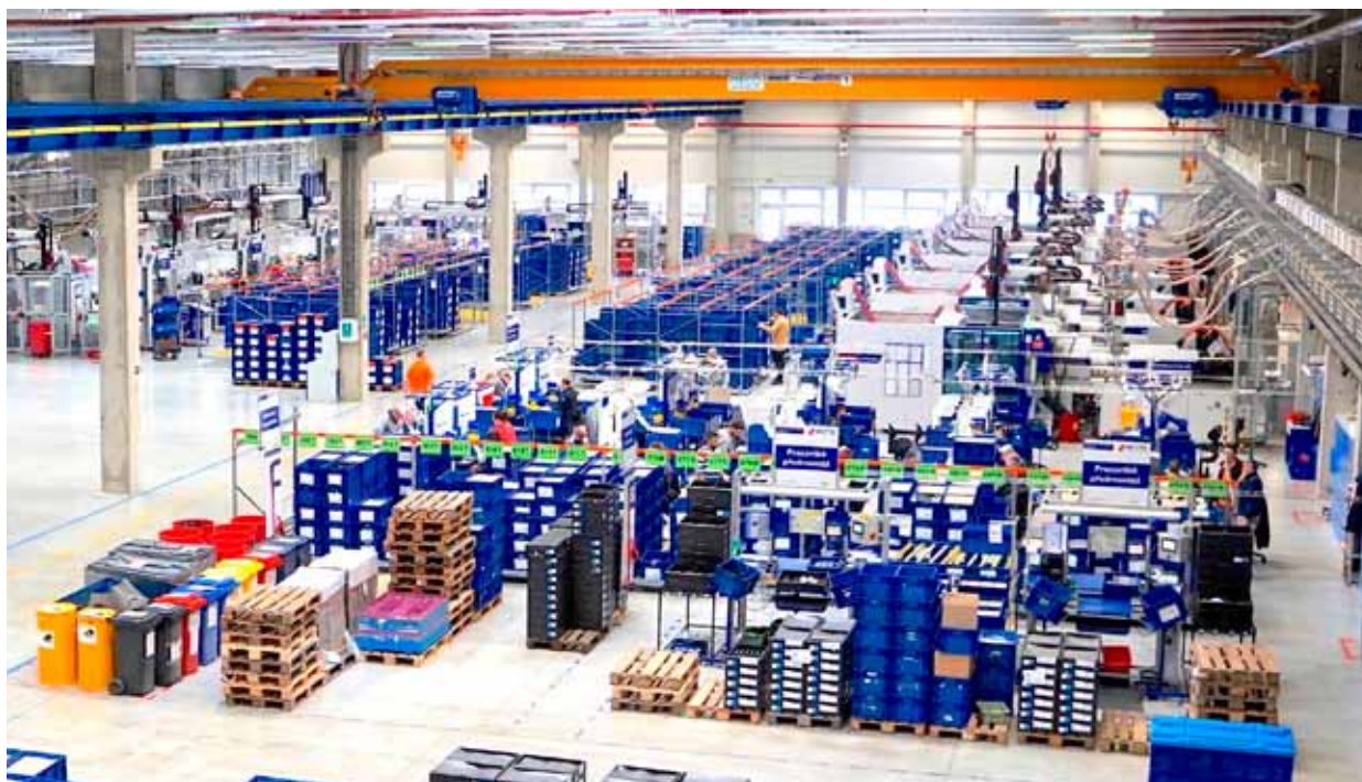
Las 14 máquinas de moldeo por inyección WITTMANN BATTENFELD en WITTE Ostrov con fuerzas de sujeción que van desde 1.800–5.500 kN, produciendo alrededor de 3,5 millones de conjuntos de manijas de puertas para automóviles por año.
