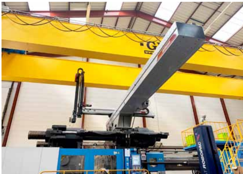
Robot WITTMANN W873XL, fotografiado durante la fase de instalación en BELLI en Bellignat, Francia.
