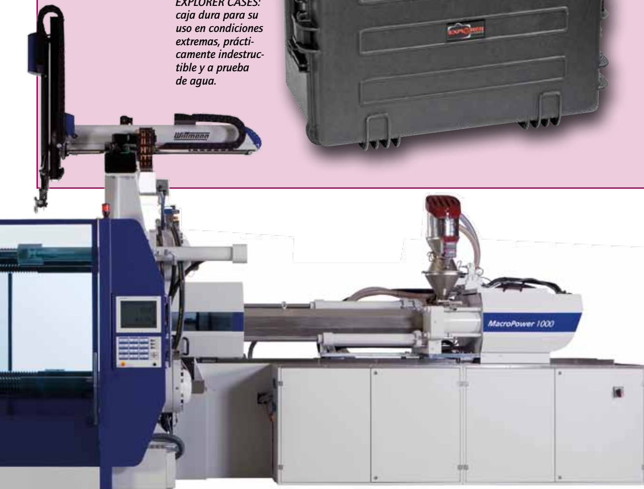
La MacroPower 1000 de la nueva serie de máquinas de WITTANN BATTENFELD a gran escala a partir de una fuerza de cierre de 1.000 toneladas.
