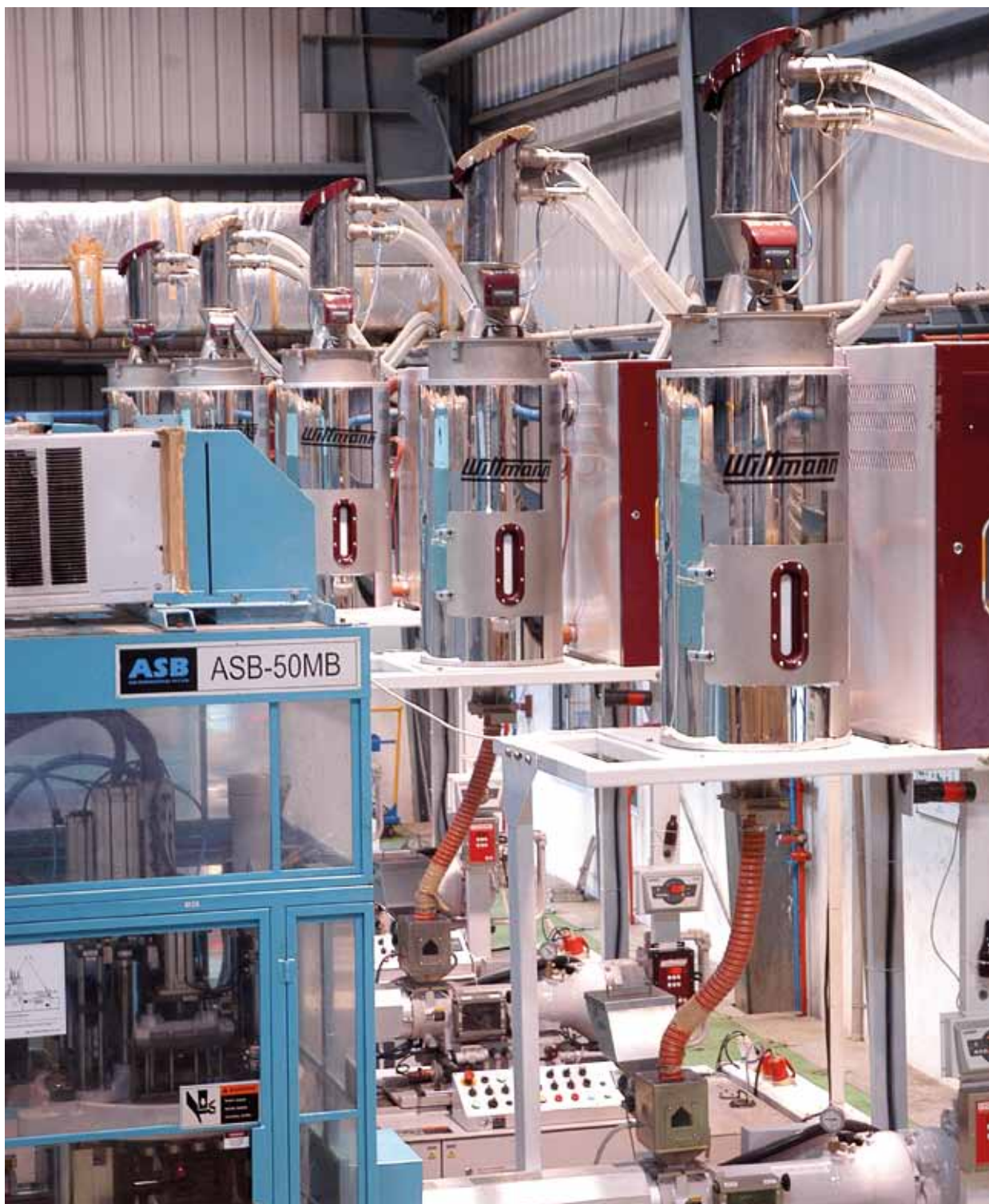
Sistema de transporte y secado en Swashtik Preforms con sede en Pondicherry. El sistema entero está dedicado al procesamiento de PET.
