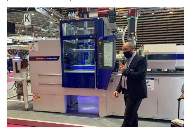
L'ensemble des équipements était intégré dans le système de commande UNILOG B8 de la presse à injecter via WITTMANN 4.0, comprenant un robot WITTMANN W918, un dessiccateur à roue ATON plus 70 et trois thermorégulateurs de la série TEMPRO plus D, ainsi que le système MES TEMI+.
