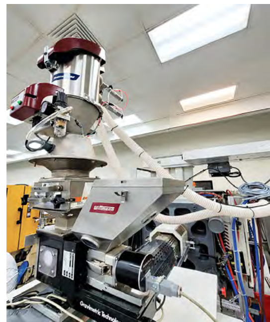
WITTMANN Fördergeräte fördern das getrocknete Material auf die Maschinen
