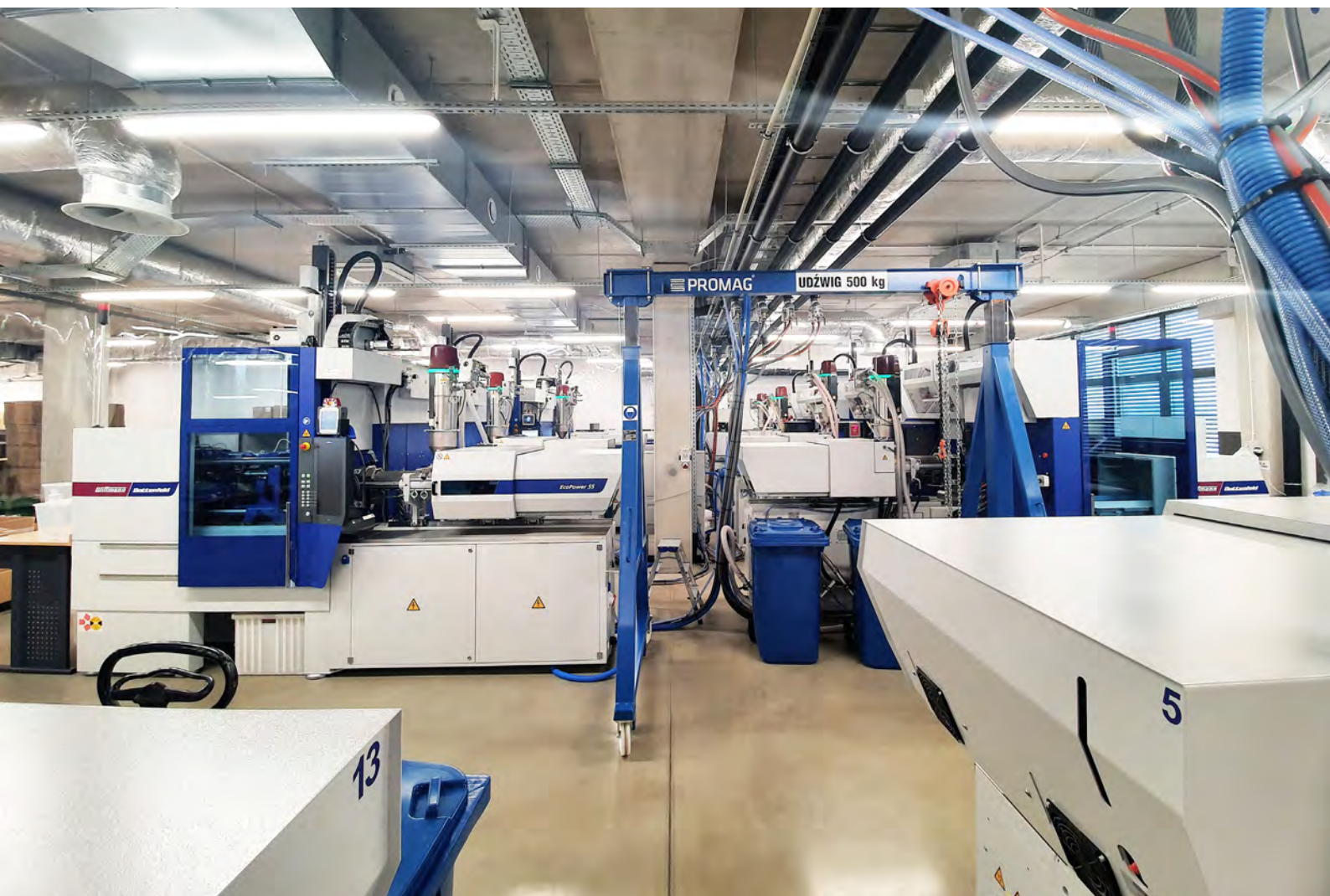
Ansichten der neuen NOEX Produktionshalle in Komorniki, Polen, für COVID-Testkits mit 16 EcoPower 55/350 Insider-Spritzgießmaschinen von WITTMANN BATTENFELD.
