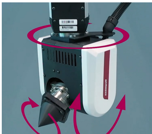
Schéma de principe des axes de rotation supplémentaires.
