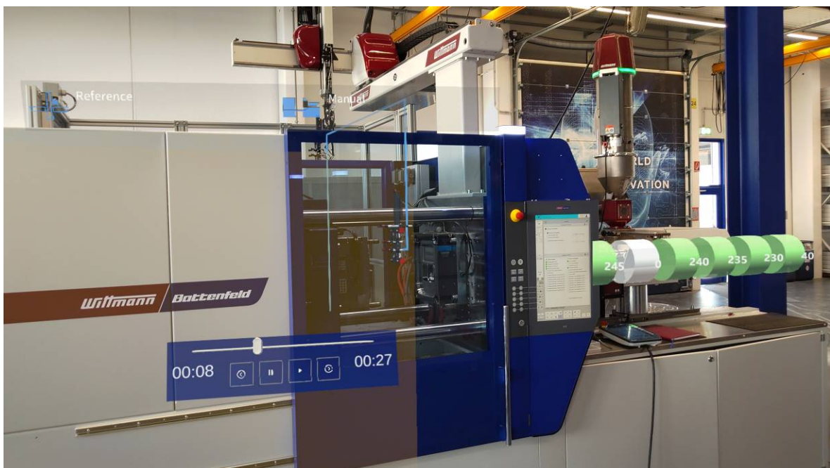
Fig. 1: Températures en réalité augmentée, de la température de la buse à la température de l'alimentation (de gauche à droite) ; fondu et animation du futur programme du robot.
