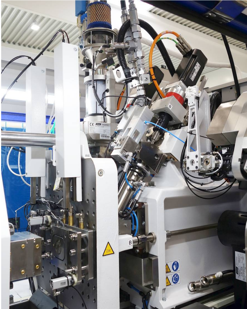
Fig. 2: Agrégats à vis et à piston en 2 étapes de la MicroPower COMBIMOULD LIM
