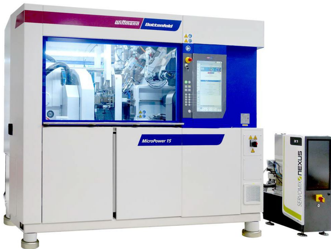
Fig. 1: MicroPower 15/10H/10H n version LIM avec unité de dosage de liquide Servomix X1 pour LSR
