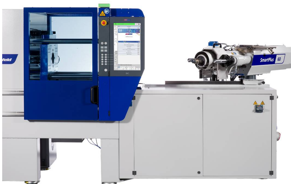
Fig. 2: Unité d'injection pivotante de la SmartPlus
