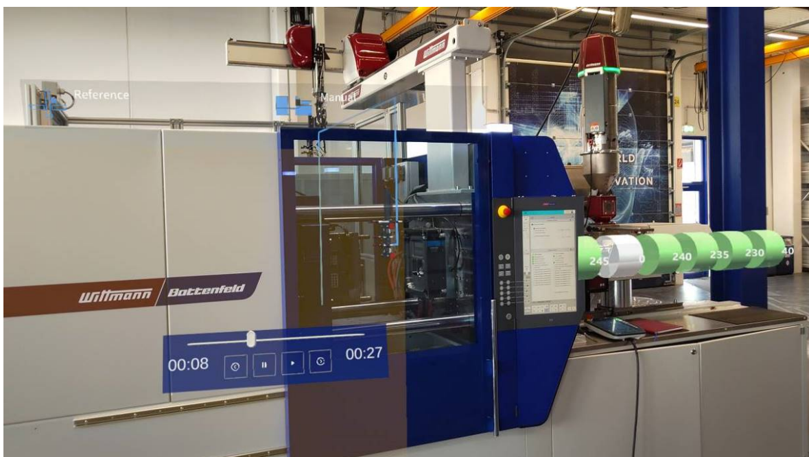
Abb. 1: Augmentierte Temperaturen der Schneckenzyylinder-Regelzonen, beginnend von der Düsentemperatur bis zur Einzugstemperatur (von links nach rechts), Einblendung und Animation des zukünftigen Programmablaufs
